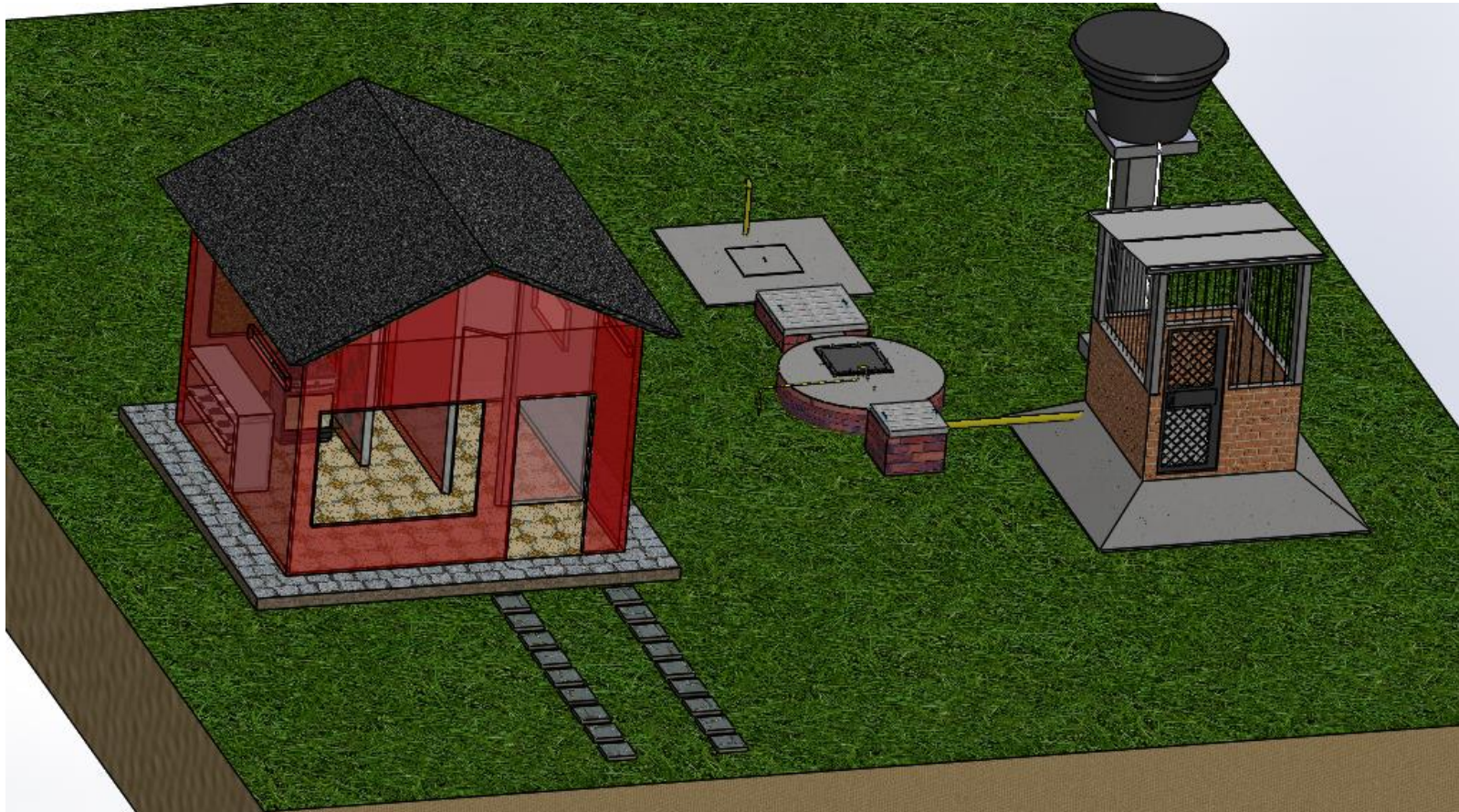
Figura 42. Ensamble de biodigestor con todos sus componentes.
