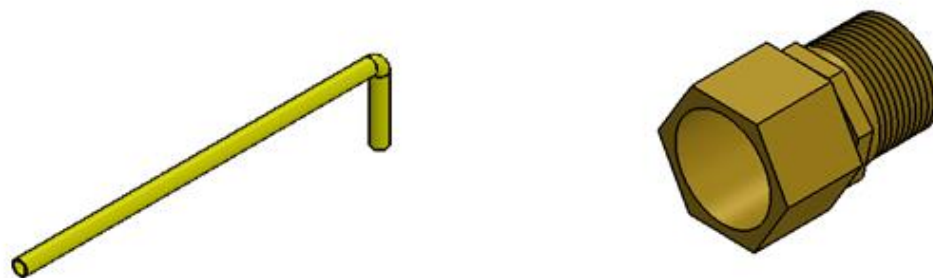
Figura 36. Tubería y terminal PE AL PE de ½" para gas.
