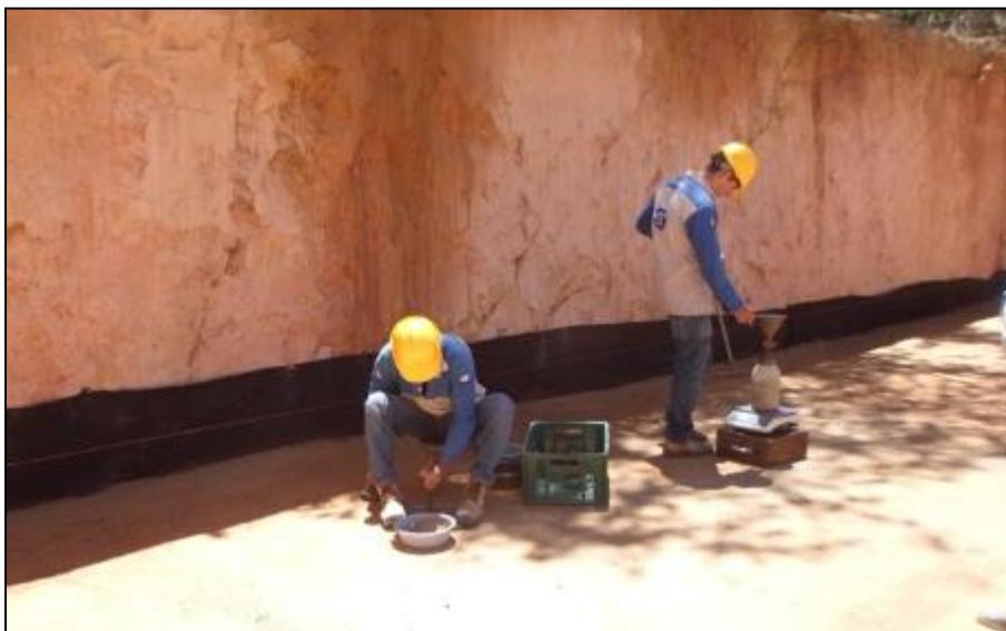
Fotografía 3. Ensayo de cono de arena en relleno tanque de almacenamiento. Fuente: Autor de la pasantía.
