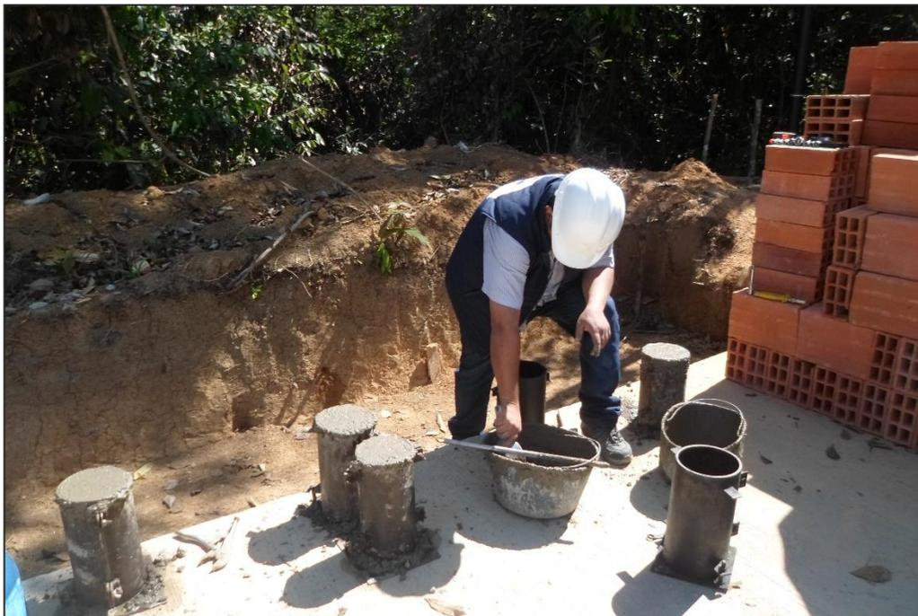
Fotografía 4. Realización de muestras cilíndricas de concreto. Fuente: Autor de la pasantía.
