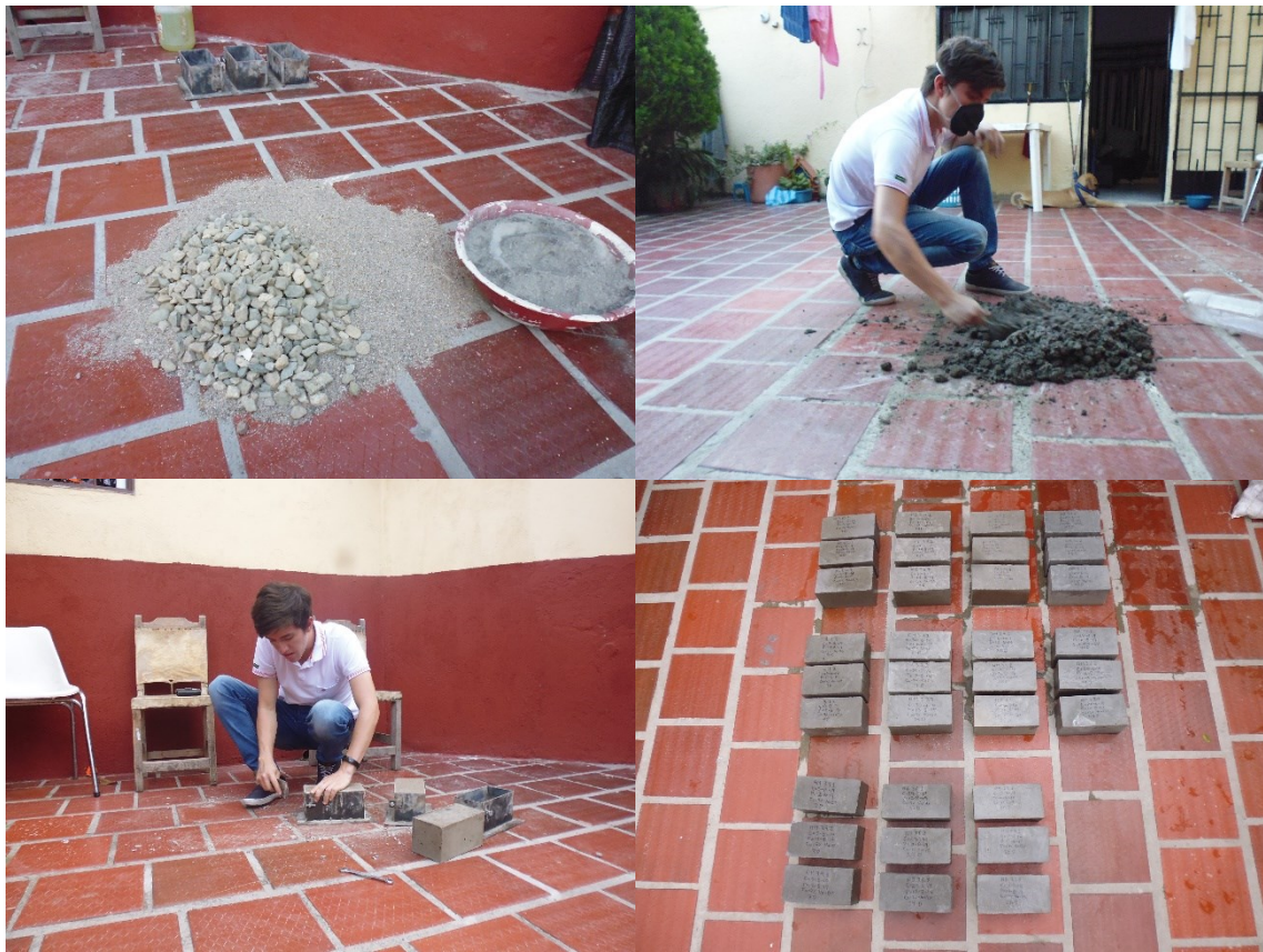
Figura 27. Elaboración, desencofrado y resultado final de adoquines. Fuente: Autor 2019.
