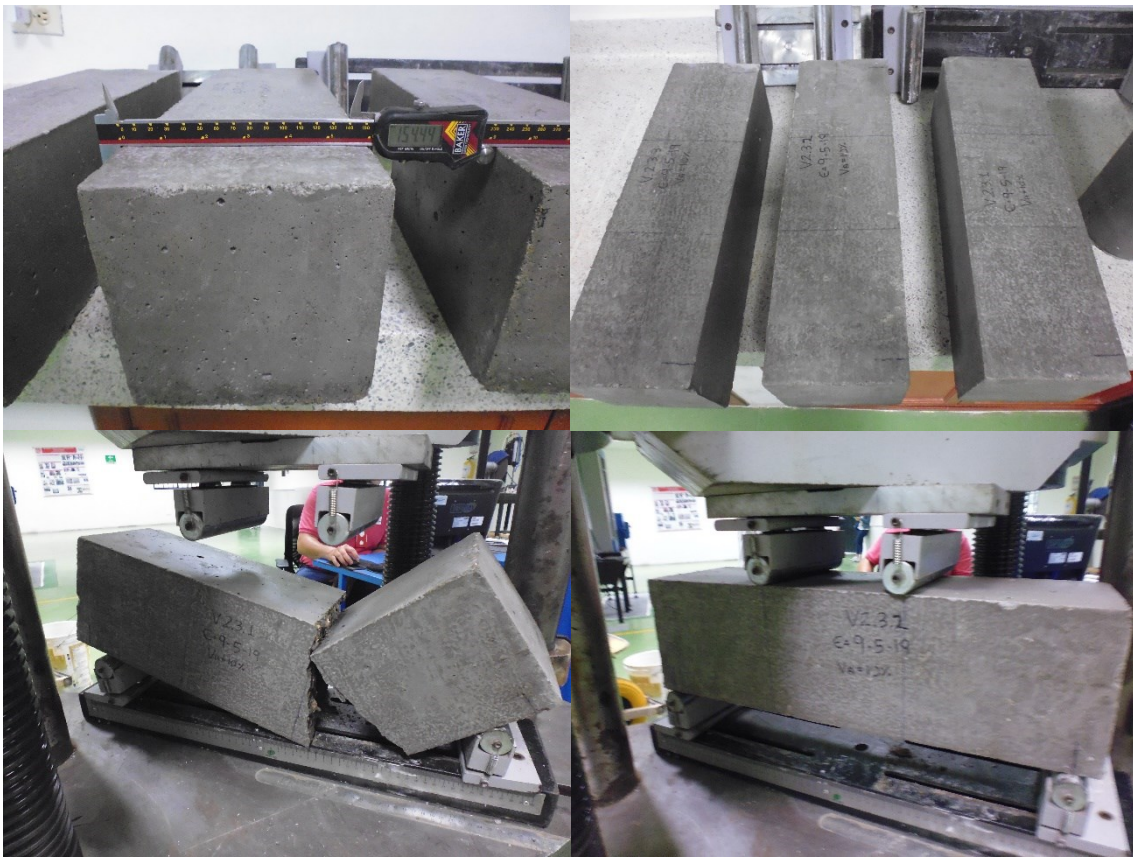
Figura 20. Ensayo a flexión de vigas de concreto. Fuente: Autor 2019.
