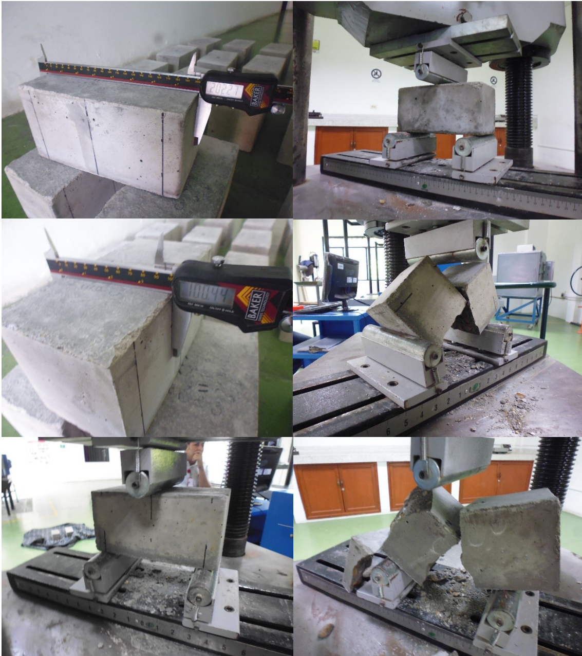
Figura 23. Medición y Ensayo de adoquines. Fuente: Autor 2019.
