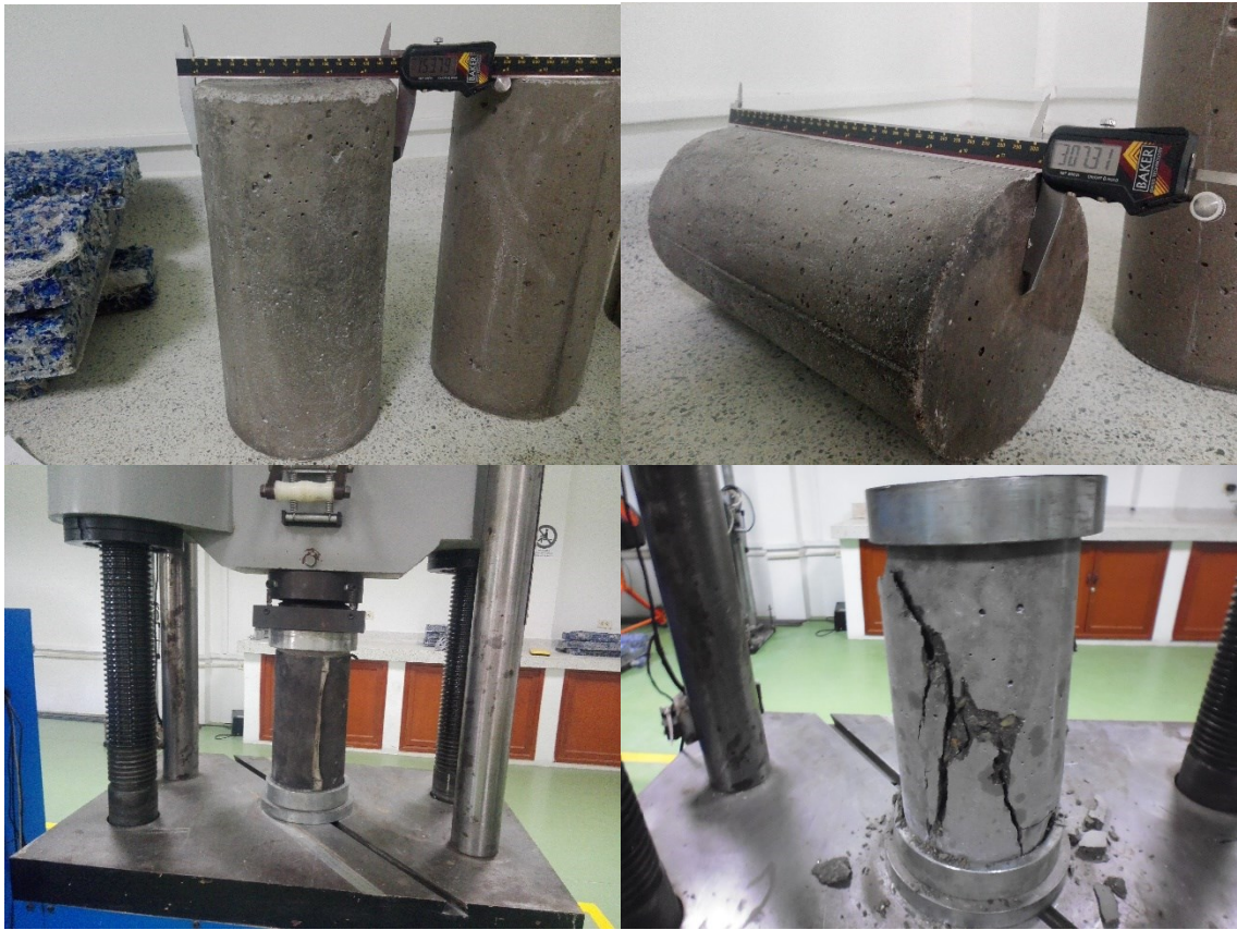
Figura 17. Ensayo a compresión de cilindros de concreto. Fuente: Autor 2019.
