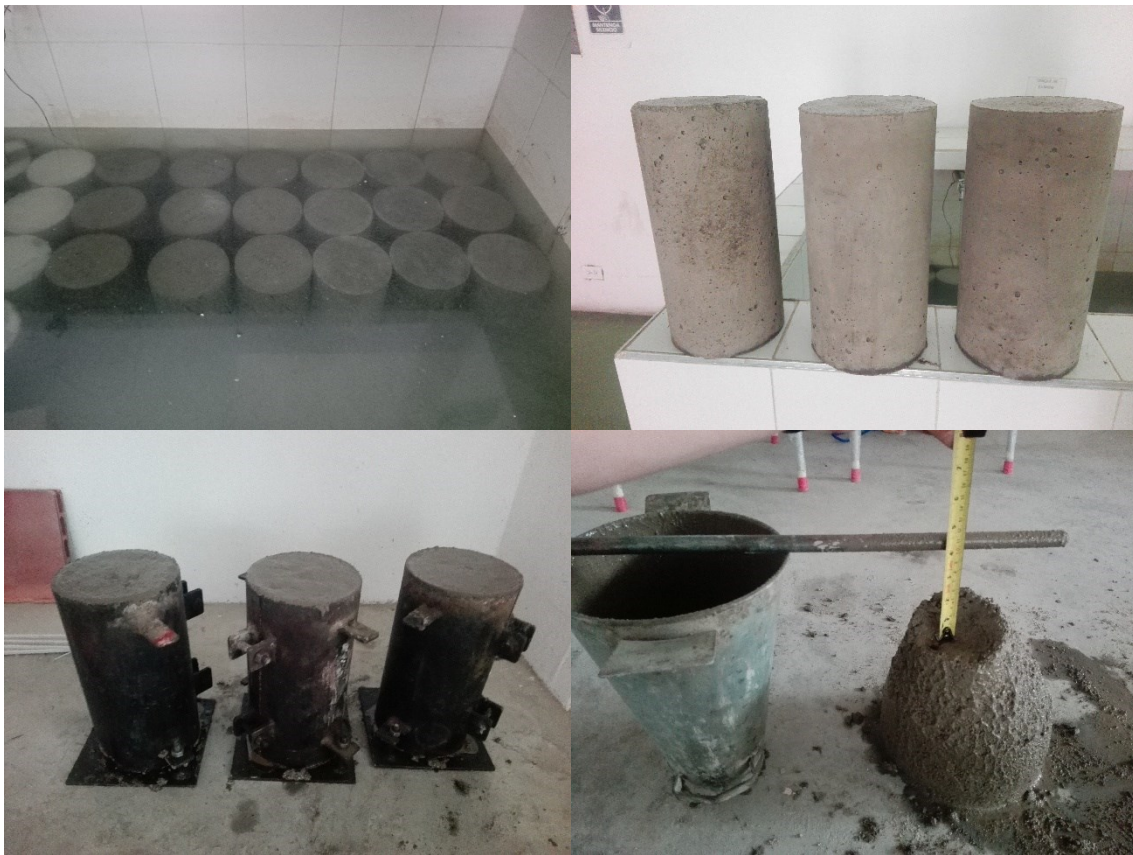
Figura 16. Cilindros de prueba. Fuente: Autor 2019.
