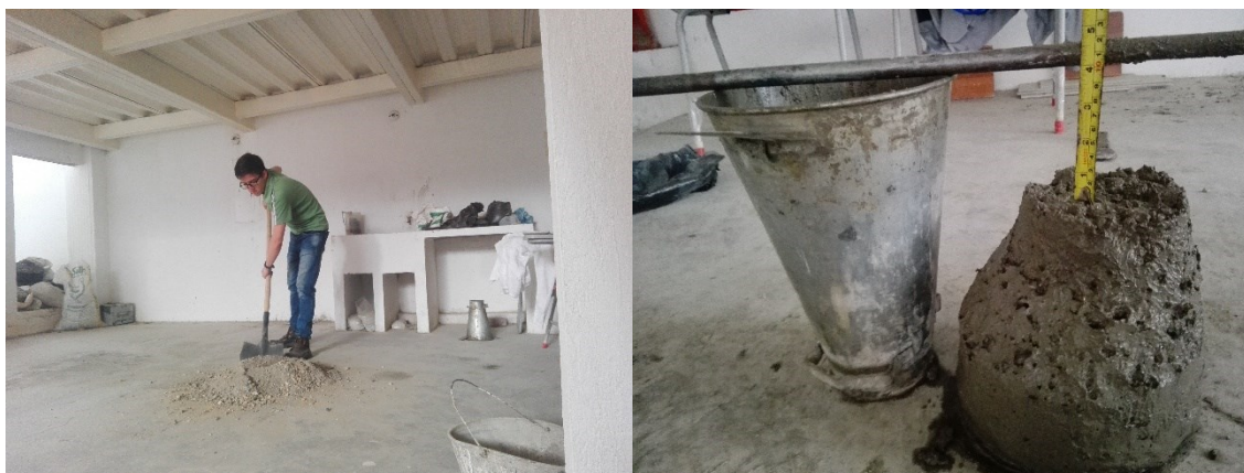
Figura 46. Mezcla de prueba. Fuente: Autor 2019.
