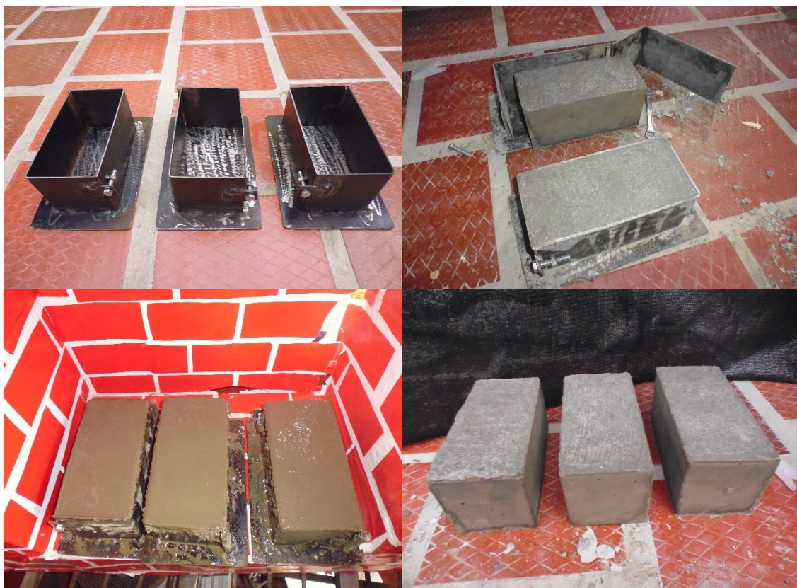
Figura 22. Molde para adoquines. Fuente: Autor 2019.
