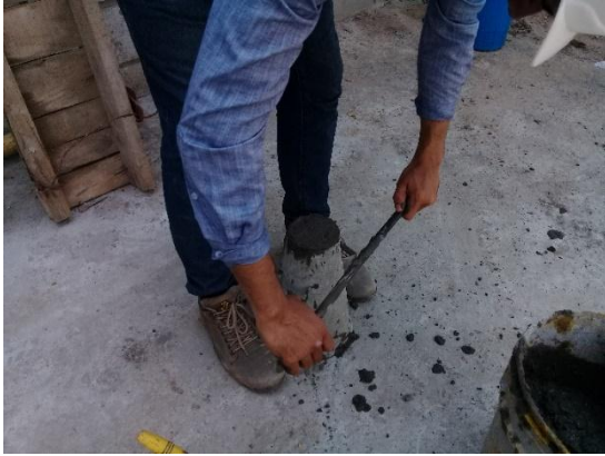
Imagen. 136. Ensayo de asentamiento del concreto.
