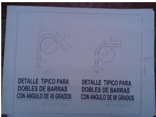
Imagen. 155. Detalle típico de dobles de barras corrugadas.
