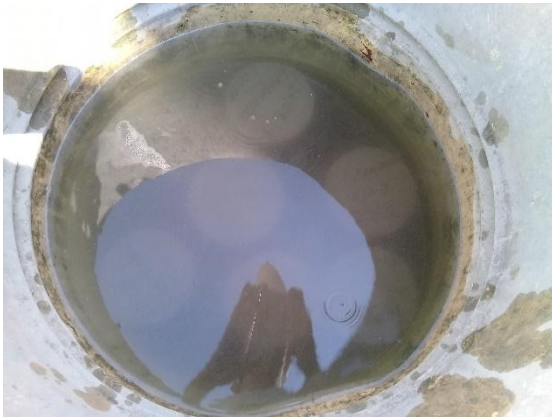
Imagen. 142. Curado provisional de probetas en obra.
