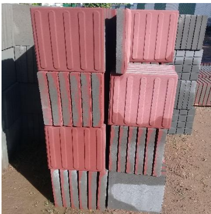
Imagen. 124... Losetas de urbanismo fabricadas in situ Tipo 3.
