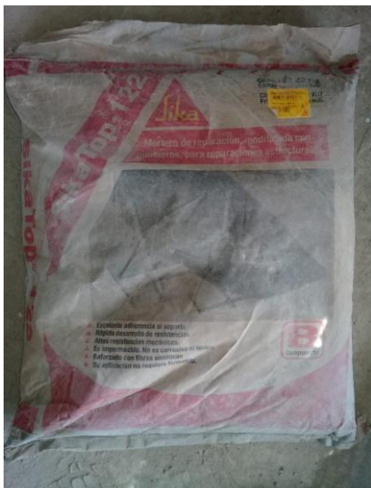
Imagen. 45. SikaTop 122. Para resane de detalles y exposición del acero.
