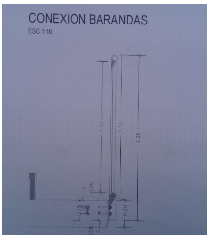
Imagen. 161. Detalle de conexión de barandas de seguridad.
