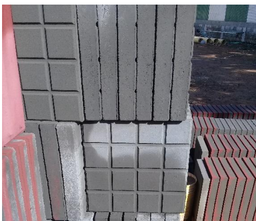
Imagen. 123. Losetas de urbanismo fabricadas in situ Tipo 2
