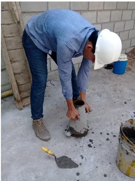
Imagen. 135. Ensayo de asentamiento del concreto
