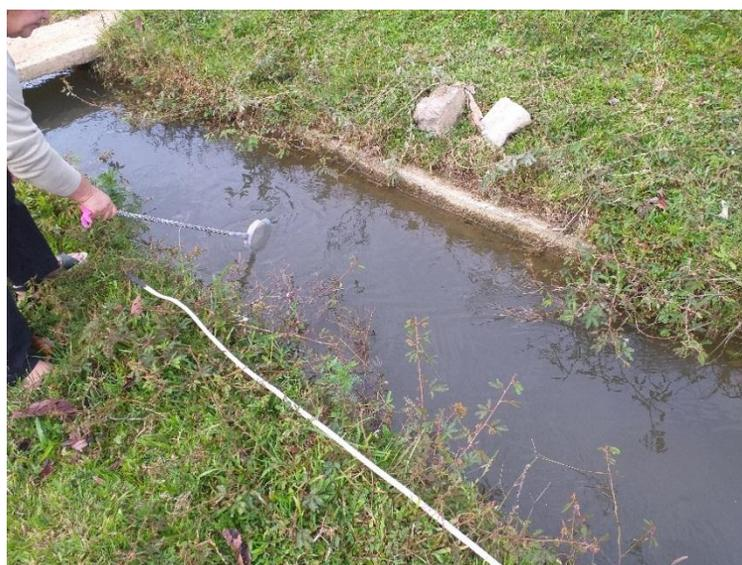
Figura 75 Toma de tiempos tras el recorrido de dos metros para el cálculo de velocidades superficiales de flujo después de dos días del retiro de sedimentación y vegetación. Coordenadas 1384353.482N 1095549.387E. Punto 94.
