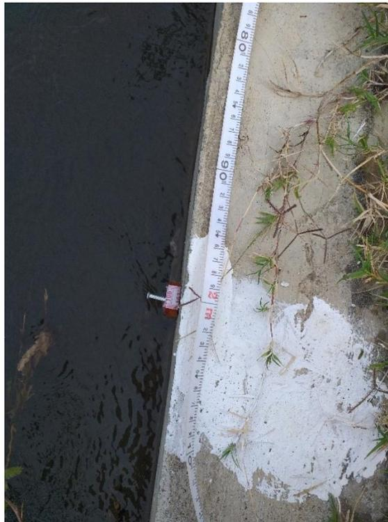
Figura 69 Distancia de 2 metros tomada para el cálculo de velocidades superficiales de flujo. Coordenadas 1384326.757N 1095559.559E. Punto 93.
