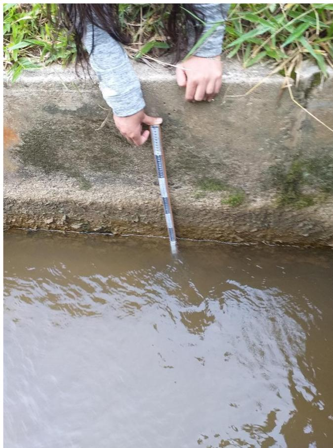
Figura 9 Medida de la altura de la lámina de agua en la bocatoma del Río Oroque.
