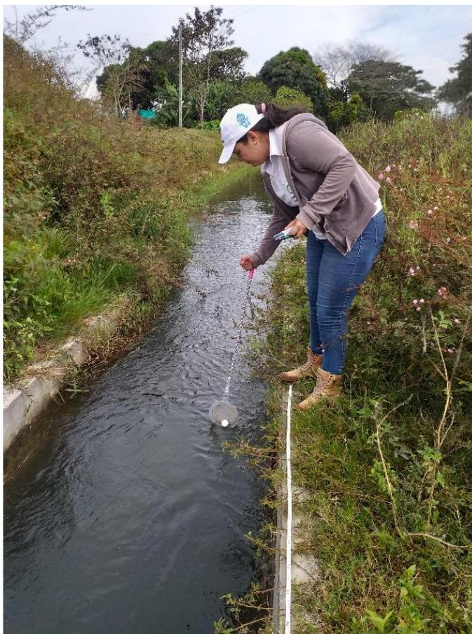
Figura 70 Toma de tiempos tras el recorrido de dos metros para el cálculo de velocidades superficiales de flujo. Coordenadas 1384326.757N 1095559.559E. Punto 93.
