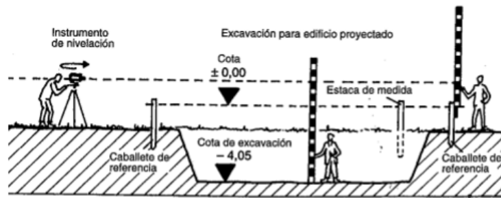
Figura 26. Toma de referencias de altura
