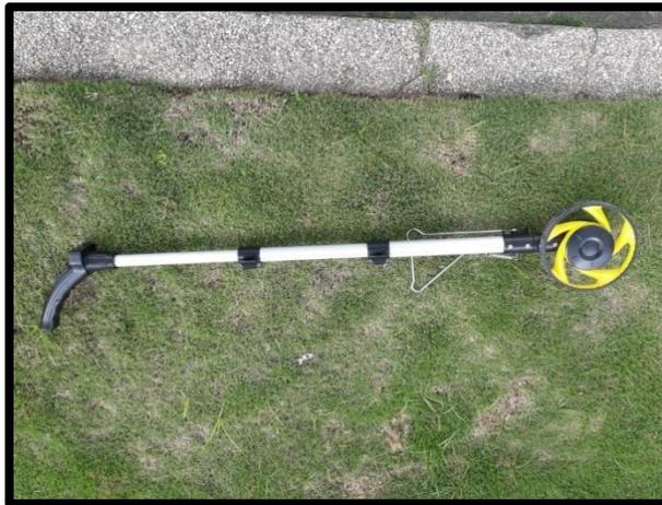
Figura 26. Odómetro de distancia utilizado para toma de longitudes de tramos de red de acueducto. Fuente. Autor
