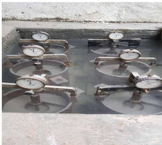
Fotografía 11. Ensayo de CBR Fuente: Autores del proyecto.
