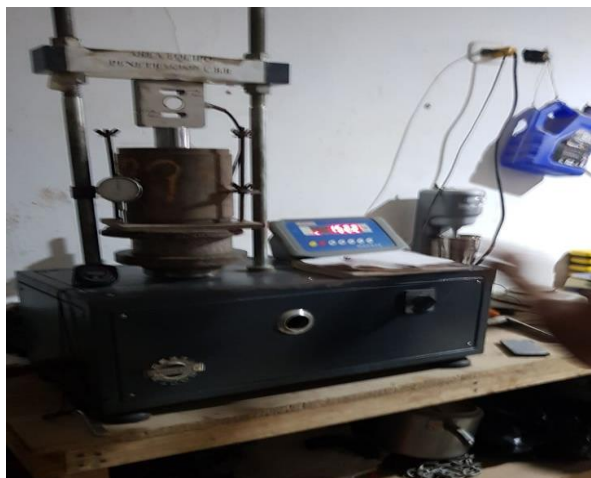
Fotografía 12. Ensayo de CBR Fuente: Autores del proyecto.
