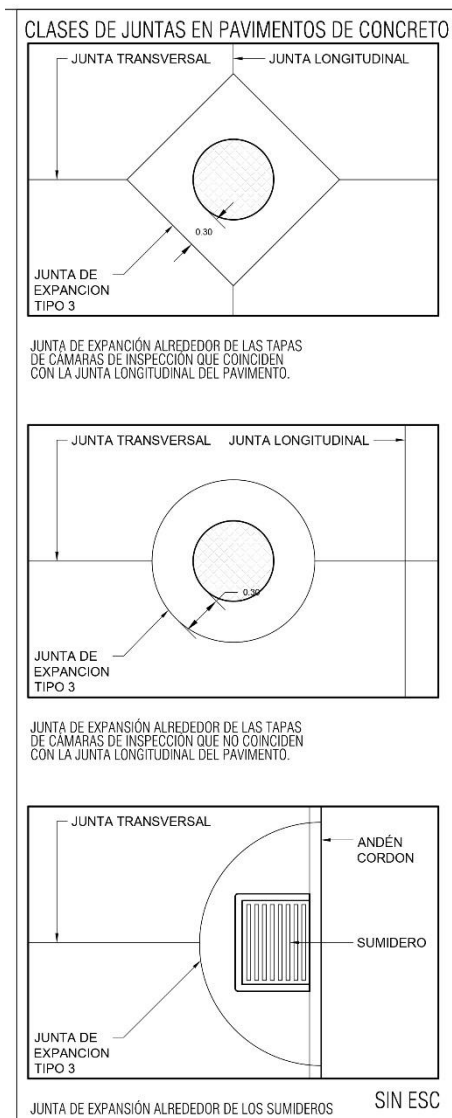
Figura 71. Clases de juntas en pavimentos de concreto
