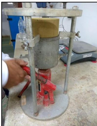
Figura 57. Extracción de probetas. Fuente: Autores del proyecto 2019
