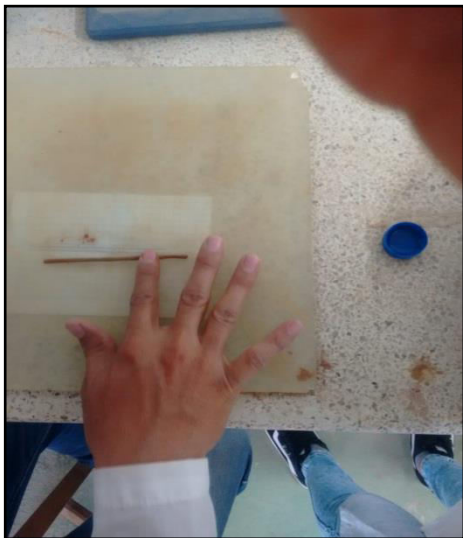
Figura 31. Realización del límite plástico. Fuente: Autores del proyecto 2019.
