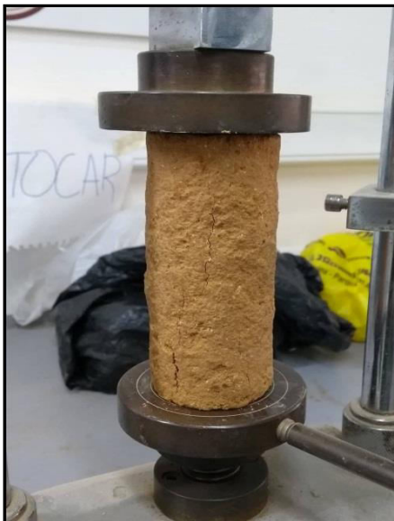
Figura 45. Aplicación de la carga axial. Fuente: Autores del proyecto 2019
