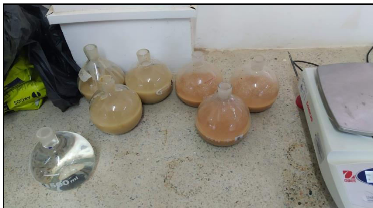
Figura 28. Enfriamiento de los picnómetros. Fuente: Autores del proyecto 2019.
