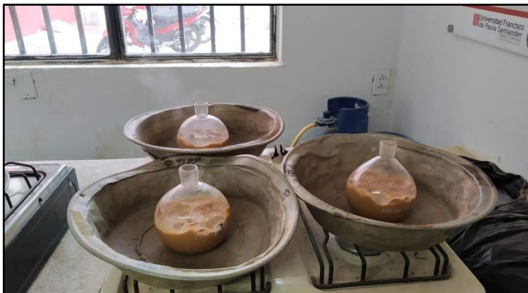
Figura 27. Cocción de las muestras en los picnómetros. Fuente: Autores del proyecto 2019.
