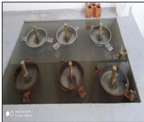
Figura 38. Inmersión de las probetas. Fuente: Autores del proyecto 2019.
