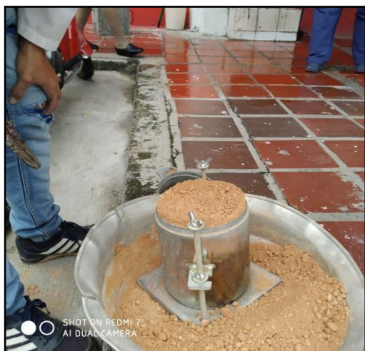
Figura 39. Remoción del collar. Fuente: Autores del proyecto 2019.
