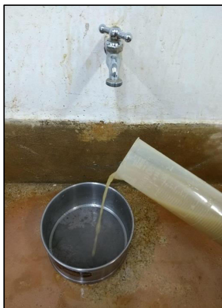
Figura 16. Lavado por tamiz N 200. Fuente: Autores del proyecto 2019.
