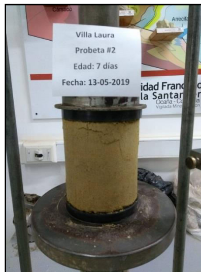
Figura 60. Falla de la probeta. Fuente: Autores del proyecto 2019.
