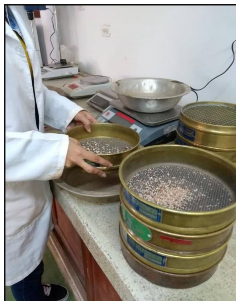
Figura 18. Tamizado de las muestras. Fuente: Autores del proyecto 2019.
