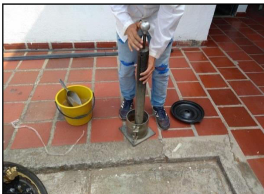
Figura 35. Compactación. Fuente: Autores del proyecto 2019.
