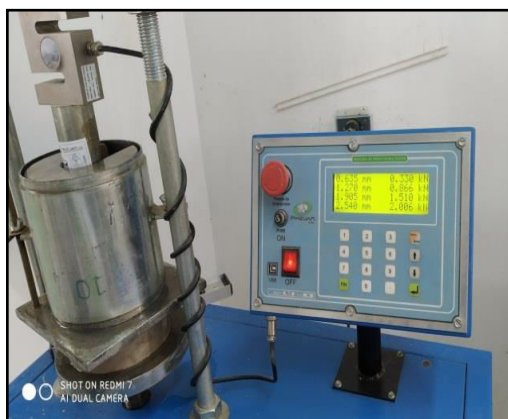
Figura 41. Colocación de la muestra en la maquina multiusos. Fuente: Autores del proyecto 2019.
