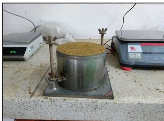
Figura 36. Enrasado de la probeta. Fuente: Autores del proyecto 2019.
