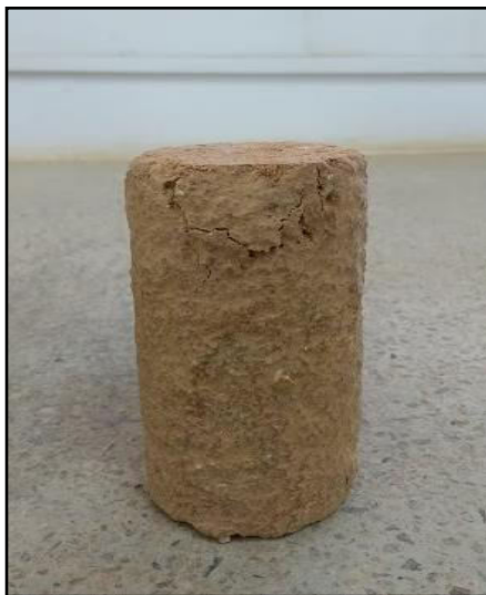
Figura 47. Falla en la probeta Circunvalar. Fuente: Autores del proyecto 2019.
