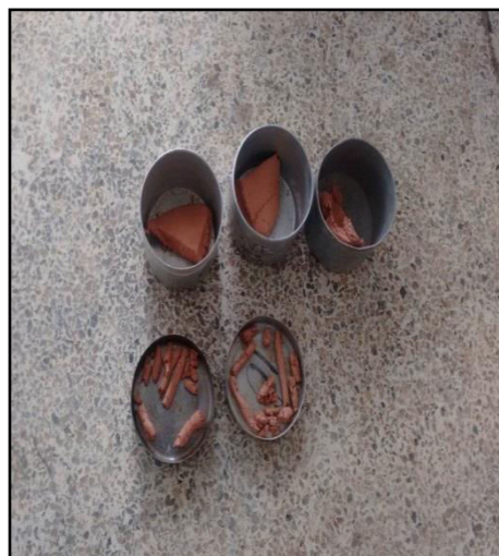
Figura 30. Límite líquido. Fuente: Autores del proyecto 2019.
