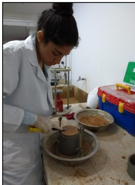
Figura 55. Enrase de la muestra compactada. Fuente: Autores del proyecto 2019.
