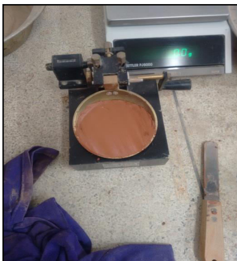
Figura 29. Preparación de la muestra en la Cazuela de Casagrande. Fuente: Autores del proyecto 2019.
