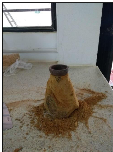
Figura 44. Tallado de muestras. Fuente: Autores del proyecto 2019
