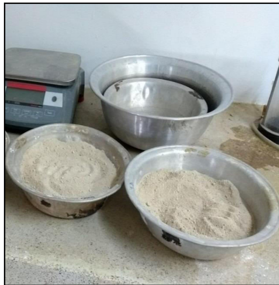
Figura 54. Mezcla suelo - cal. Fuente: Autores del proyecto 2019.
