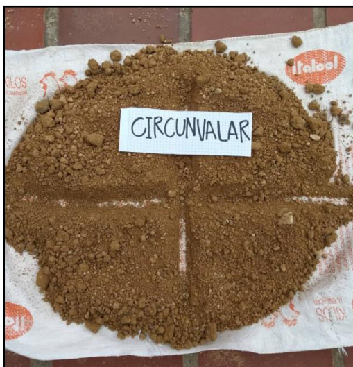
Figura 14. Preparación de muestras de suelo seco. Fuente: Autores del proyecto 2019.
