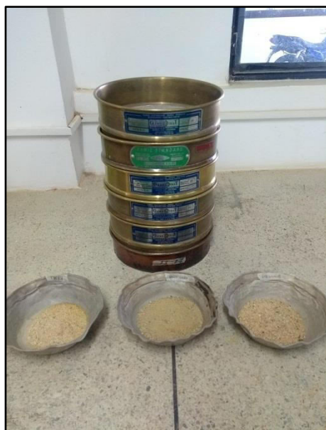
Figura 17. Muestra seca para tamizado. Fuente: Autores del proyecto 2019.
