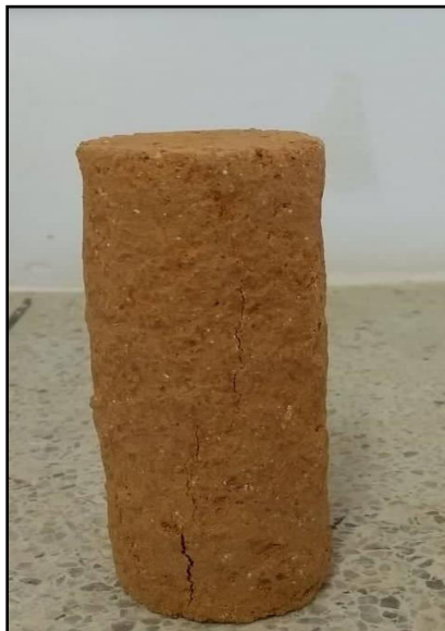
Figura 46. Falla en la probeta Villa Laura. Fuente: Autores del proyecto 2019.
