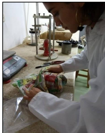
Figura 58. Envoltura de probetas en papel periódico. Fuente: autores del proyecto 2019.
