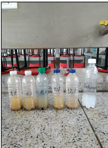
Figura 51. Muestra con porcentajes de cal. Fuente: Autores del proyecto 2019.
