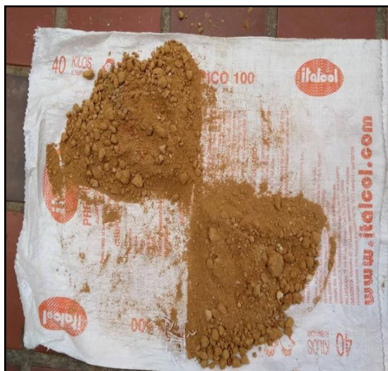
Figura 13. Obtención de porciones representativas. . Fuente: Autores del proyecto 2019.
