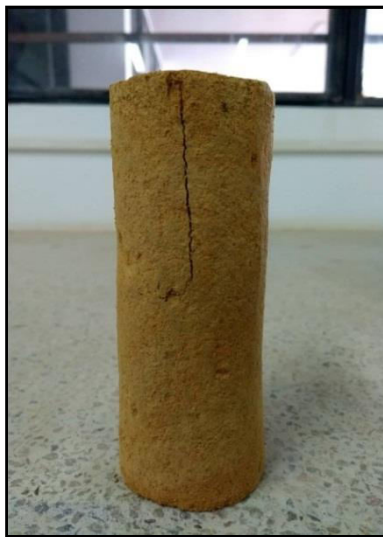
Figura 48. Falla en la probeta Limonia. Fuente: Autores del proyecto 2019.
