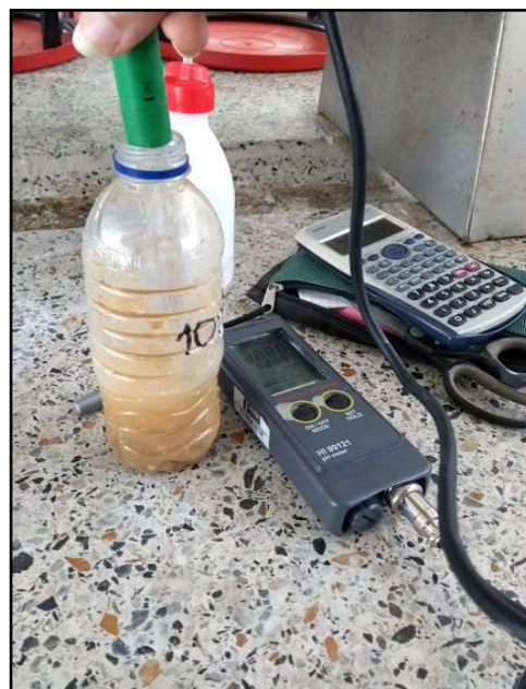
Figura 52. Toma de la medida del pH. Fuente: Autores del proyecto 2019
