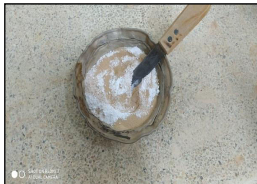
Figura 63. Mezcla suelo – cal. Fuente: Autores del proyecto 2019.
