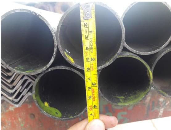
**Figura 8. Comprobación de los tamaños nominales de las tuberías.**
