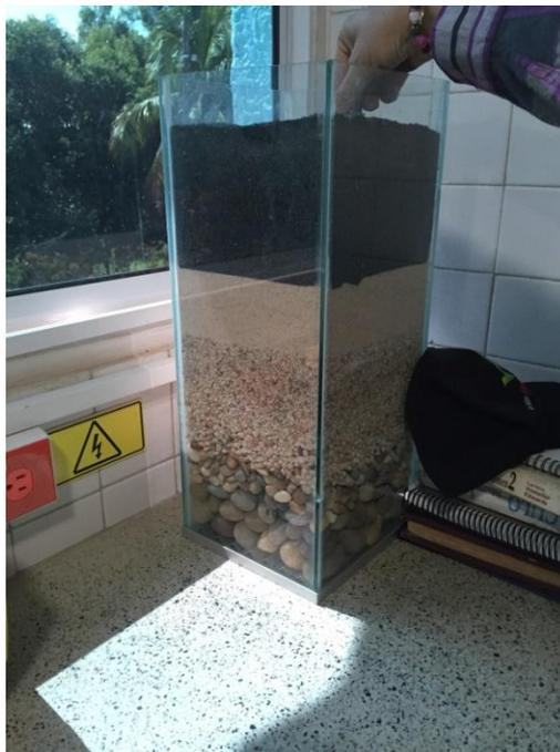
*Figura 6. Prototipo del lecho filtrante.*
