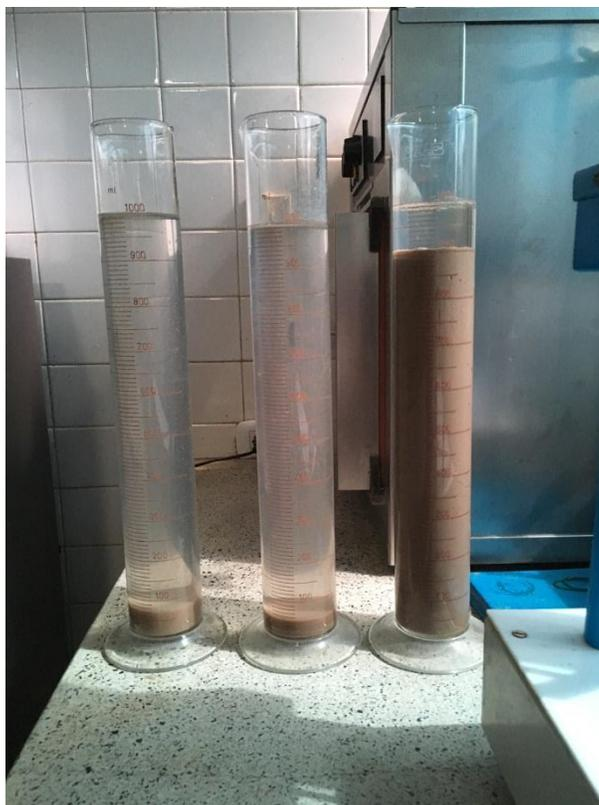
*Figura 33: lodos sedimentados en probetas de 1000ml.*
