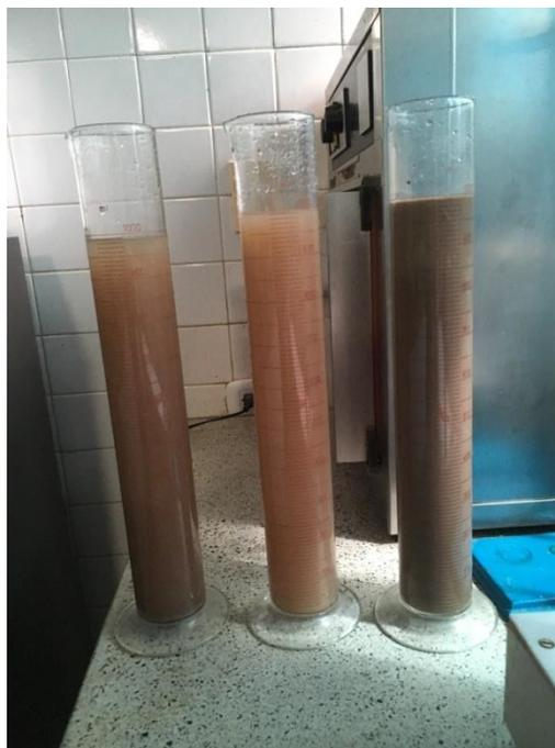
*Figura 32. Muestras de lodos en probetas de 1000 ml.*
