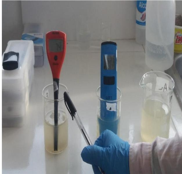
*Figura 72. Phmetro y conductimetro*
