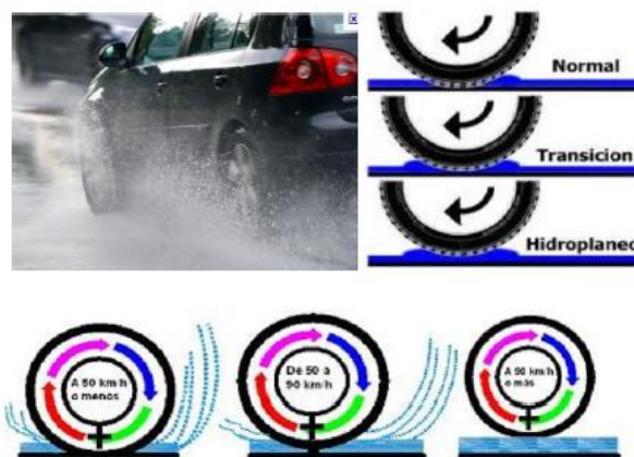
Figura 22. Representación del fenómeno de hidropneumático
