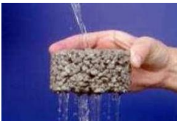
Figura 9. Permeabilidad de la mezcla asfáltica porosa o drenante
