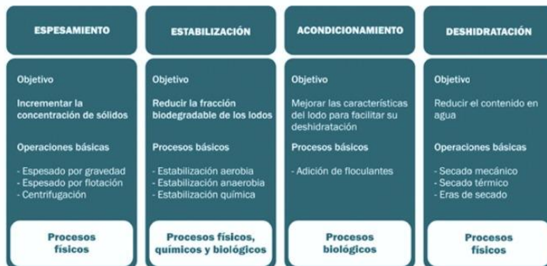
Figura 2. Tratamiento en la línea de lodos.
