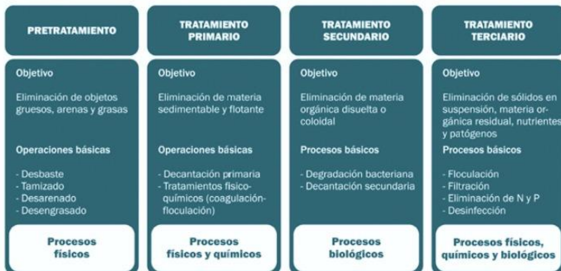
Figura 1. Etapas de la línea de agua, ordenadas secuencialmente de izquierda a derecha, en el tratamiento de aguas residuales urbanas.
