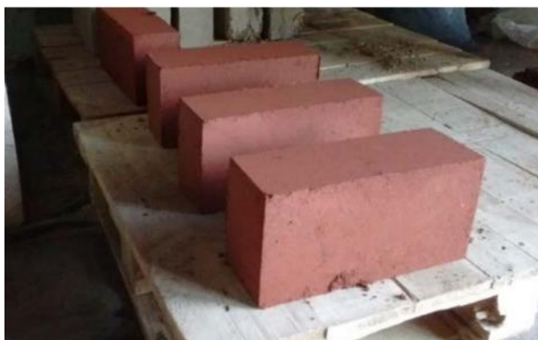
Figura 17. BTC de suelo-cemento macizo de 10x14x29 cm. Obtenido de: Bloques de tierra comprimida y tapia: dos técnicas con capacidad portante.
