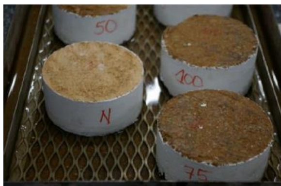
Figura 24. Probetas cilíndricas de tierra comprimida usadas para realizar ensayos al material. Obtenido de: (Cañola, Jaramillo, Medina, & Castañeda, 2018).
