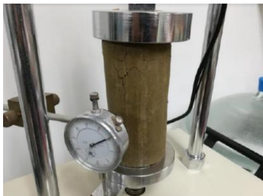
Figura 29. Estado de la muestra con 5% de cemento al final del ensayo. Obtenido de: (Echevery & Jaramillo, 2017).
