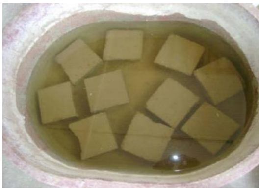
Figura 30. Detalle de la prueba de absorción. Obtenido de: (Morales, Ortiz, & Alavéz, 2007).
