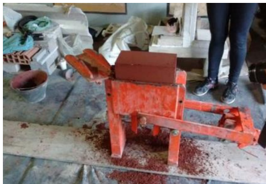
Figura 18. Prensa manual CINVA-RAM con medidas de 29x10x14 cm. Obtenido de: Bloques de tierra comprimida y tapia: dos técnicas con capacidad portante.
