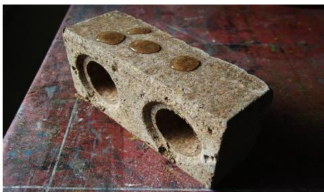
Figura 25. Bloque de tierra comprimida de 9.5x14x29.5cm con adición de emulsión asfáltica. Obtenido de: (Cañola, Jaramillo, Medina, & Castañeda, 2018).
