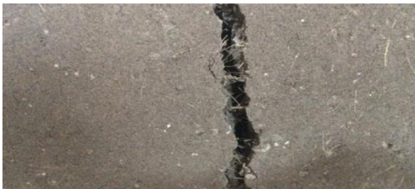
Figura 28. Fibras de plátano que unen las grietas en el BTC durante la falla. Obtenido de: (Mostafa & Uddin, 2016).
