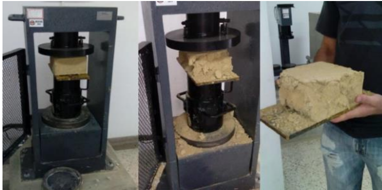
Figura 34. Ensayo a compresión a bloques individuales. Obtenido de: (Londoño, Parra, & Vallejo, 2015).
