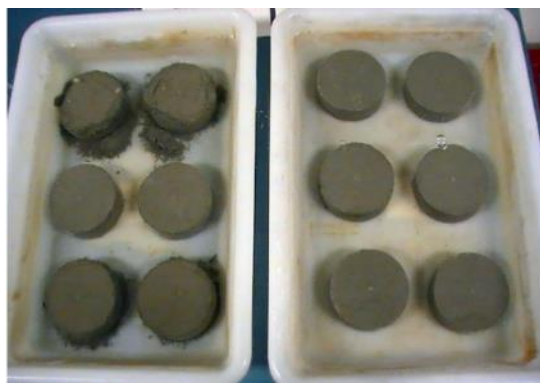
Figura 31. Bandejas de ensayo de las probetas a inmersión. Obtenido de: (Laguna, 2011).
