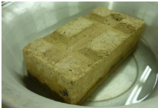
Figura 23. Ensayo de absorción. Obtenido de: (Bustamante & Mendoza, 2017).
