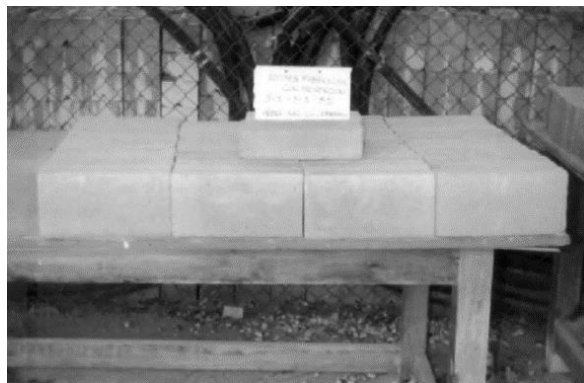
Figura 20. BTC fabricado en la investigación de Roux & Espuna. Obtenido de: Bloques de Tierra Comprimida adicionados con fibras naturales, 2012.
