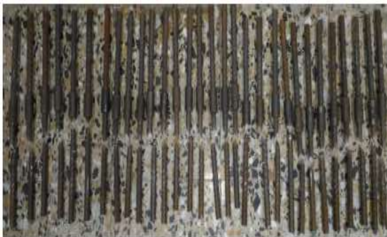
Figura 23. Probetas con empalme después de la falla a tracción Fuente: Alvis Fonseca & Guerra Bejarano, 2017. Análisis técnico, económico y constructivo del uso de empalmes mecánicos roscados en edificaciones, p.30.
