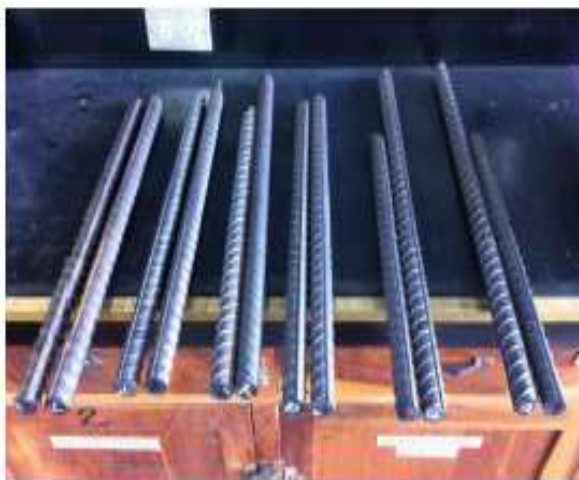
Figura 21. Probetas de acero después de sufrir la rotura en el ensayo de tensión. Fuente: Vargas Fernández, 2015. Análisis de la resistencia a tensión y costos de empalmes mecánicos usados en barras de acero de refuerzo (con conectores prensados y atornillados tipo 2), p.47.
