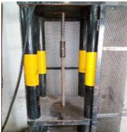
Figura 25. Ensayo de las probetas de acero empalmadas con conectores mecánicos Fuente: Gonzáles & Cuevas Florián, 2018. Estudio comparativo entre empalmes por traslape y empalmes mecánicos utilizados en elementos de hormigón armado, p.49.
