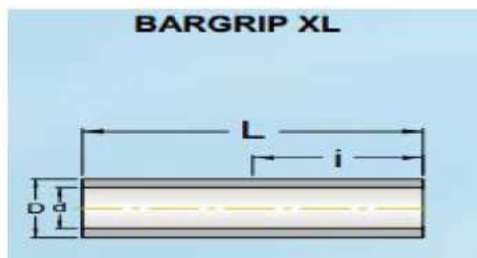
Figura 36. Corte transversal del conector mecánico BarGrip XL
