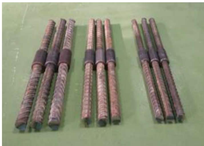
Figura 27. Probetas de acero empalmadas mecánicamente Fuente: Autores, 2019.
