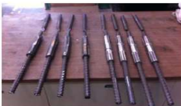
Figura 22. Empalmes mecánicos elaborados para el ensayo de tensión. Fuente: Vargas Fernández, 2015. Análisis de la resistencia a tensión y costos de empalmes mecánicos usados en barras de acero de refuerzo (con conectores prensados y atornillados tipo 2), p.58.
