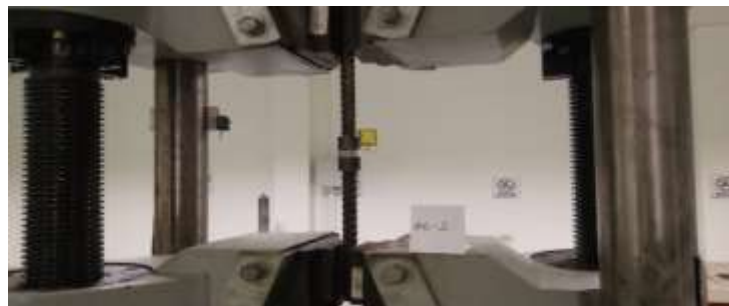
Figura 29. Aplicación de la carga axial a las probetas de acero Fuente: Autores del proyecto, 2020
