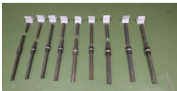
Figura 30. Probetas de acero después realizar el ensayo de tracción Fuente: Autores del proyecto, 2020.
