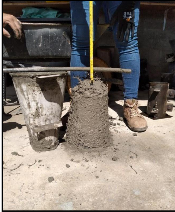
Figura 10. Procedimiento del cálculo de asentamiento (Slump) para elaboración de cilindros. Fuente: Autores (2021).
