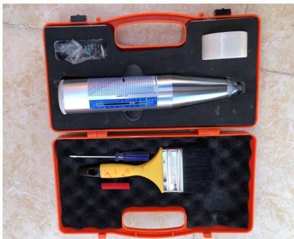
*Figura 20*Equipo de esclerómetro. Fuente: Autores, 2020
