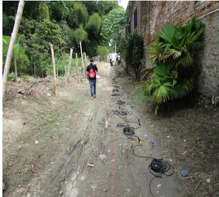
Figura 8. Ubicación de sensores para ensayo de refracción sísmica y Masw, 2019, obtenido de GIGMA.
