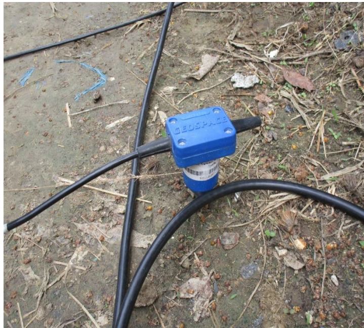
Figura 7. Geófono de 14.5 Hz para ensayo de refracción sísmica, 2019, Obtenido de GIGMA.
