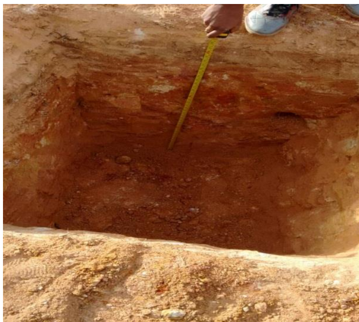
Figura 1. Excavación manual apique, 2017. Autores.
