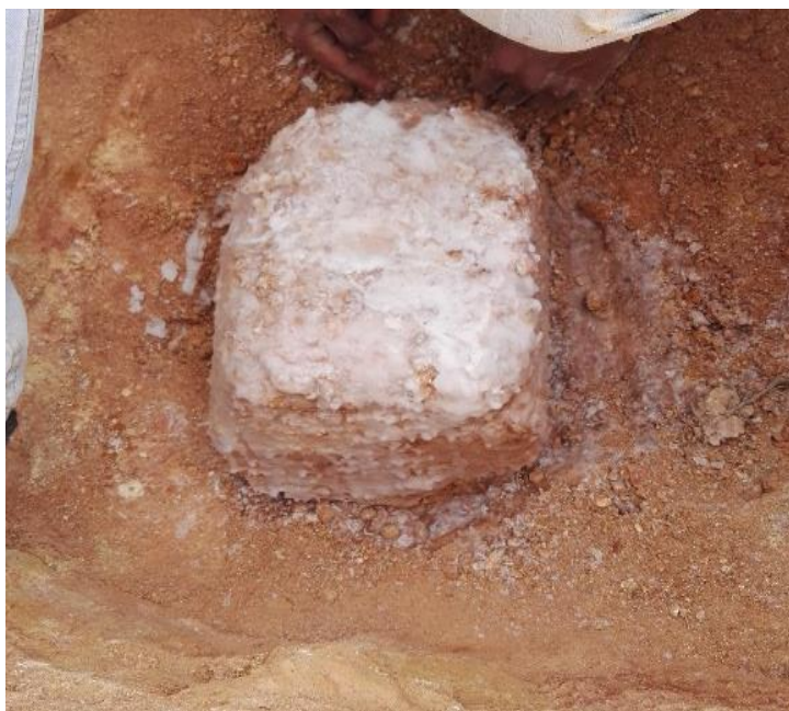
Figura 2. Muestra tipo terrón con parafina, 2017. Autores.
