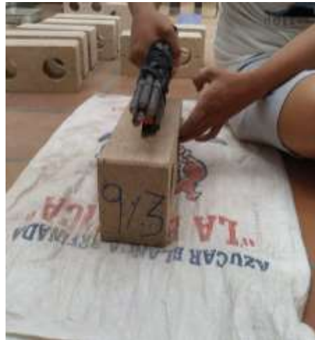
Figura 21. Realización del ensayo de abrasión
