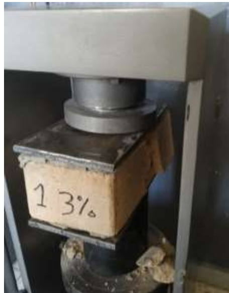
Figura 19. Realización del ensayo de compresión
