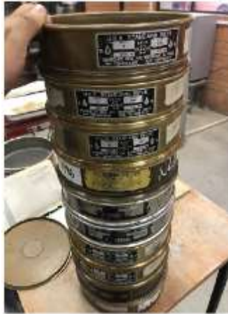
Figura 4. Tamices para ensayo de granulometría
