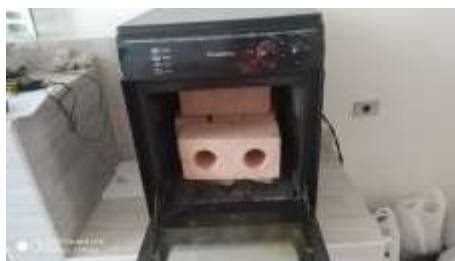
Figura 10. Secado de los bloques en el horno
