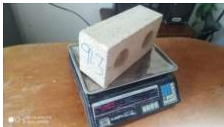
Figura 25. Registro del peso final de los bloques al finalizar el ensayo de erosión
