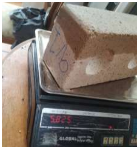
Figura 15. Registro del peso final de los bloques
