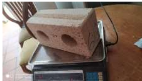
Figura 22. Registro del peso final de los bloques
