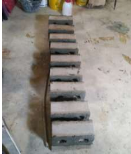
Figura 18. Almacenamiento de los bloques con el mortero antes del ensayo de compresión
