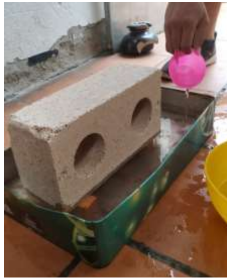
Figura 14. Adición de agua durante el ensayo para mantener el nivel de agua
