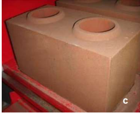
Figura 2. Bloque de Tierra Comprimida (BTC) con huecos
