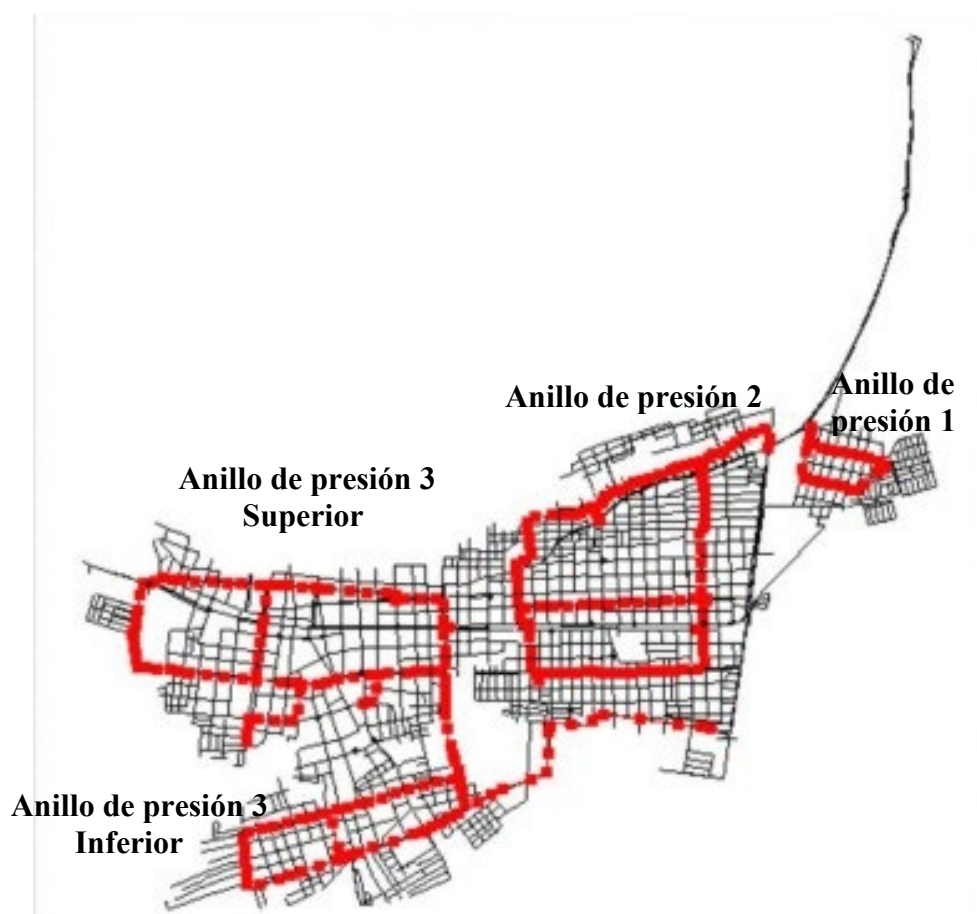
Figura 3. Plano de la red existente (Negro) y sistemas de Anillos de presión proyectados (Rojo)
