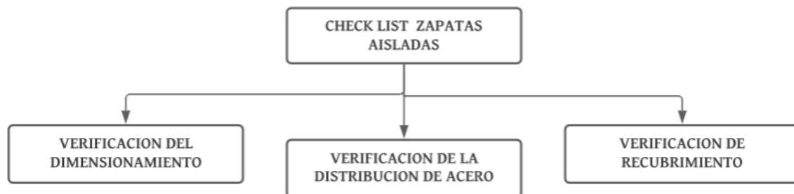
Figura 63. Supervisión técnica de zapatas aisladas
