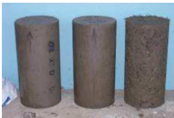
Figura 5. Muestra de Concreto con diferentes porcentajes de fibra de bagazo.
