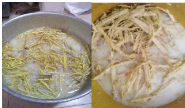
Figura 37. Proceso de inmunización fibras húmedas y secas.
