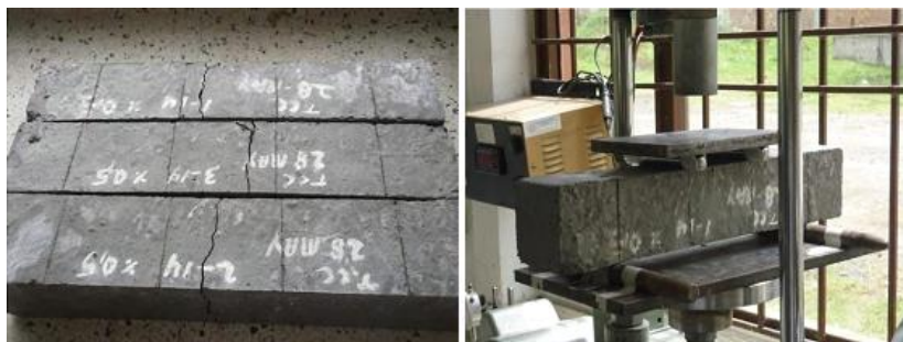
Figura 14. Ensayo a flexión de probetas con diferentes porcentajes de fibra de bagazo de caña.
