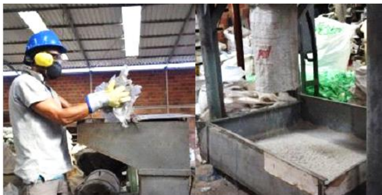
Figura 28. Proceso corte de plástico, MallaPET 3D.
