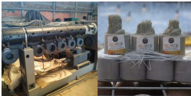
Figura 29. Proceso de extrusión, homogenización y empaçado, MallaPET 3D.
