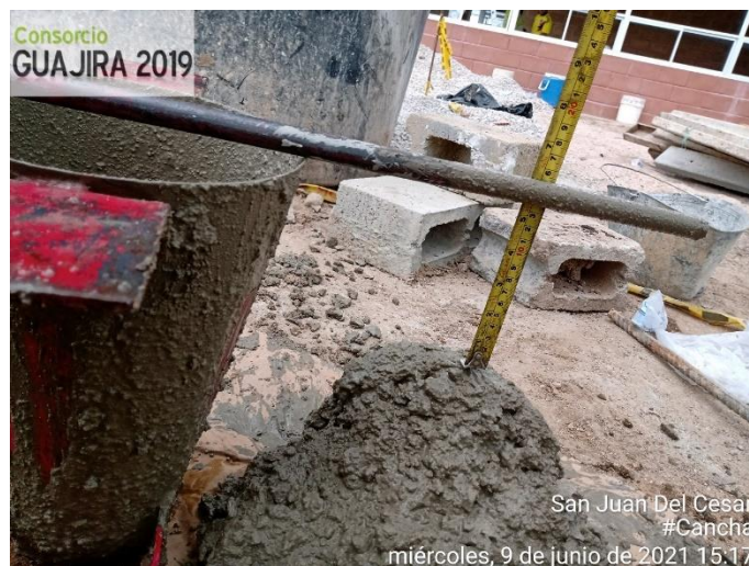
Figura 48. Ensayo asentamiento del concreto usado en cancha múltiple. Fuente pasante
