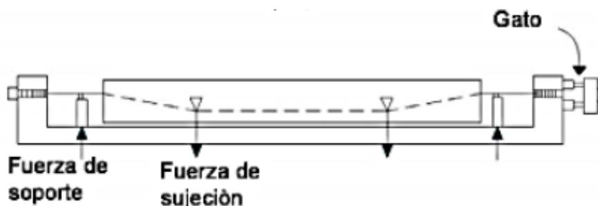
Figura 26. Aplicación de las fuerzas de presfuerzo y de las fuerzas de soporte en vigas. Palacios, L., 2018. *Concreto pretensado y postensado*. Pág. 6.
