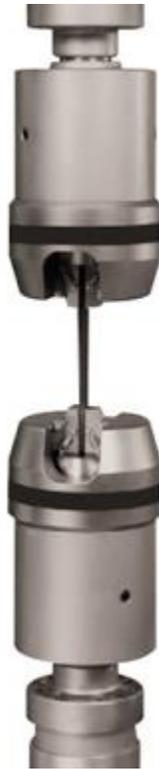
*Figura 55.* Mordazas especiales con canales lisos semicilíndricas empleadas para el ensayo a tracción de torones. Obtenido en: <https://www.instron.es/es-es/products/testing-accessories/grips/torsion-axial-torsion-grips>
