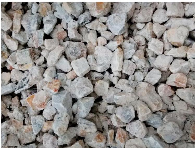
*Figura 33.* Barita triturada para su uso en el concreto. Brasilminas.com, 2021. Obtenido en: <https://brasilminas.net/comprar-barita-industrial/>
