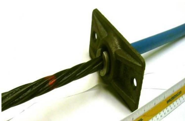
*Figura 16.* Anclaje pasivo generalmente usado en concretos postensados. Edingaps, 2021.
