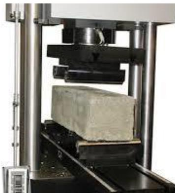
*Figura 38. Determinación de la resistencia del concreto a la flexión de acuerdo a la NTC-2871. Instron.com.ar, 2021. Obtenido de: <https://www.instron.com.ar/es-ar/testing-solutions/by-test-type/flexure/astm-c78>*
