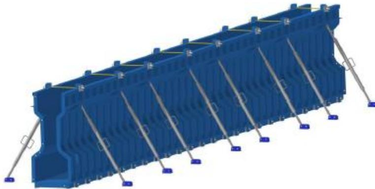
*Figura 23. Molde de vigas para fabricación con concretos preesforzados y postensados. Méndez, 2015. Principios prácticos para la prefabricación y aplicación de presfuerzo en concreto. Pág. 26.*
