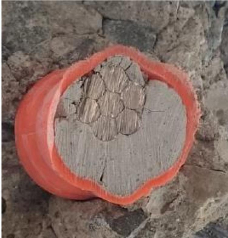
*Figura 29. Ductos de concreto postensado después del endurecimiento del mortero de inyección. Quintanilla, D., 2016. Ensayos experimentales en vigas de concreto postensado con tendones adheridos y no adheridos. Pág. 16.*
