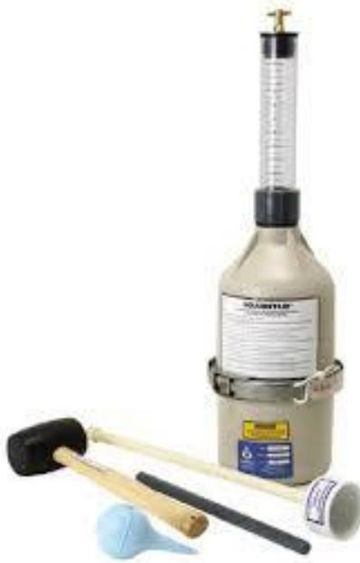
Figura 34. Equipo necesario para obtener el contenido de aire en el concreto de acuerdo a la NTC-1028. Runco.com, 2021. Obtenido en: <http://www.runco.com.ar/sitio/IMG/pdf/Hormigon.pdf>
