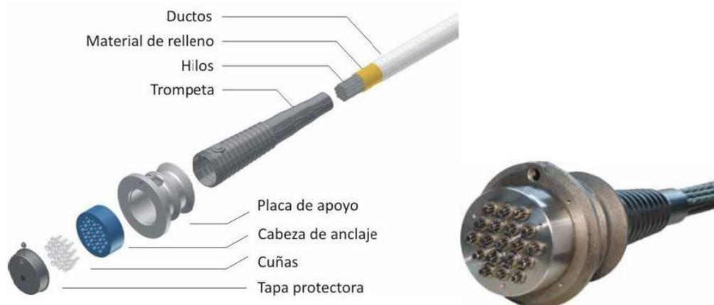
*Figura 10.* Esquema de los componentes de un anclaje activo multitorón y su aspecto característico. Torres, A. & Morales, F., 2011. *Sistemas constructivos: Hormigón pretesado y postesado*. Pág. 32.
