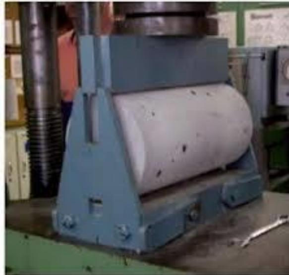
*Figura 37.* Obtención de la resistencia a la tensión indirecta de cilindros de concreto de acuerdo a la NTC-722. Masqueingeniería.com, 2021. Obtenido de: <https://masqueingenieria.com/blog/ensayos-a-traccion-indirecta-del-hormigon/>
