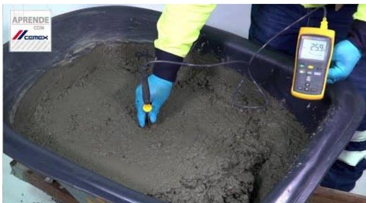
*Figura 31.* Obtención de la temperatura de una muestra de concreto. Labmexco.com, 2021.
