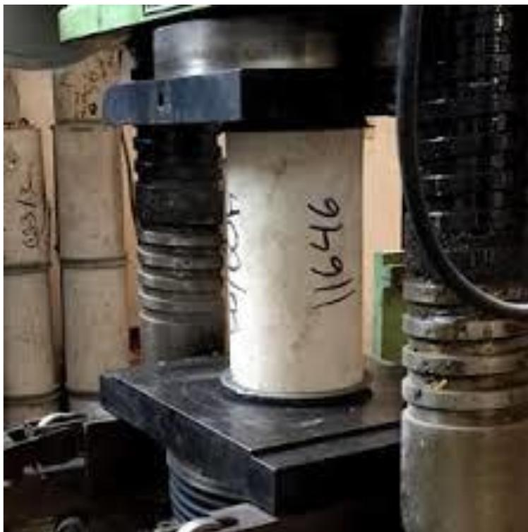
*Figura 36.* Obtención de la carga axial máxima de compresión en cilindros de concreto de acuerdo a la NTC-1032. Ibertest.es.com, 2021. Obtenido en: <https://www.ibertest.es/products/maquina-de-ensayo-para-materiales-de-alta-resistencia-la-compresion-serie-meh/>
