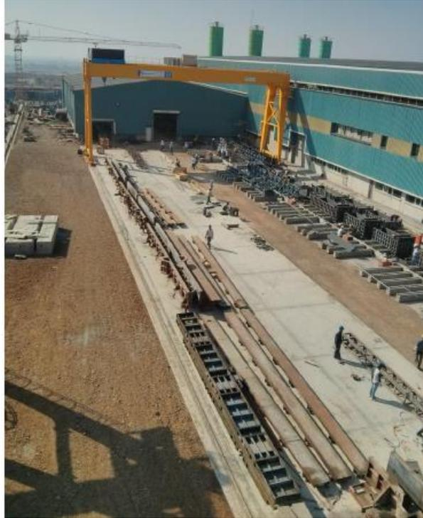
*Figura 24. Mesa de colado. Méndez, 2015. Principios prácticos para la prefabricación y aplicación de presfuerzo en concreto. Pág. 28.*
