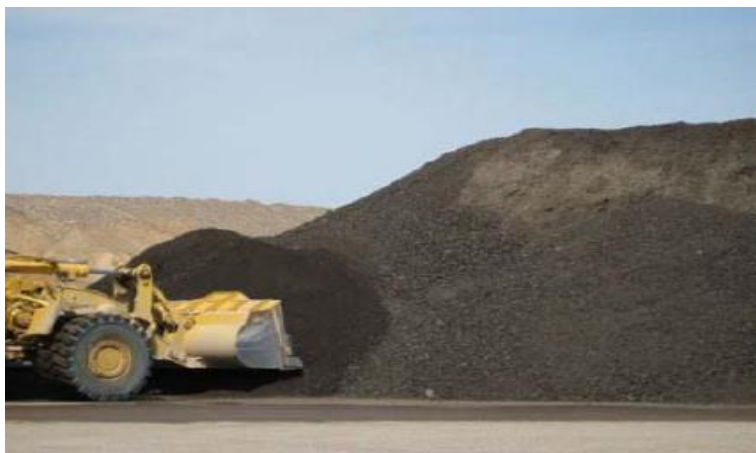
Figura 5. Acopio del RAP. Zúñiga, 2016. Mezcla asfáltica en caliente con pavimento asfáltico recuperado RAP, p. 6.
