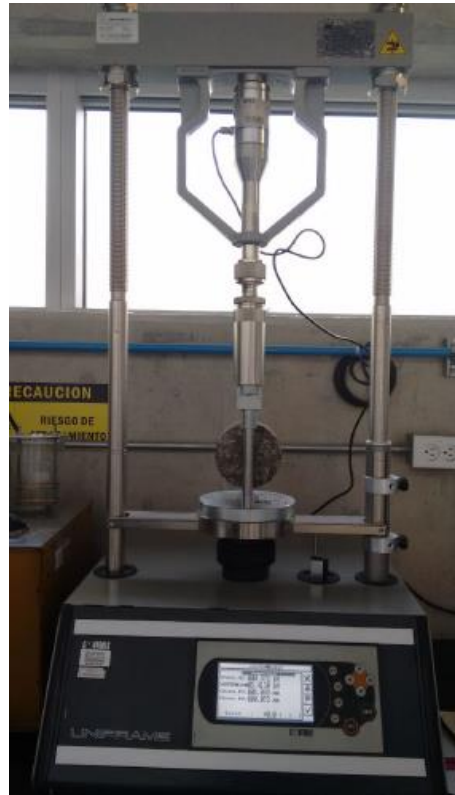
Figura 25. Realización de ensayo de tracción indirecta. Castro, 2018. Investigación sobre mezclas asfálticas en frío 100% recicladas con adición de residuos sólidos, p. 87.
