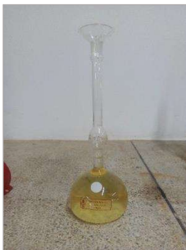
Figura 18. Ensayo determinación de la densidad del cemento hidráulico, frasco de le chatelier con querosene hasta marca de gradación.
