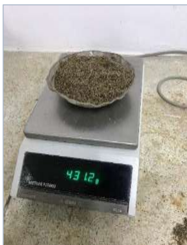
Figura 8. Ensayo determinación del contenido de humedad del agregado, pesaje muestra húmeda.
