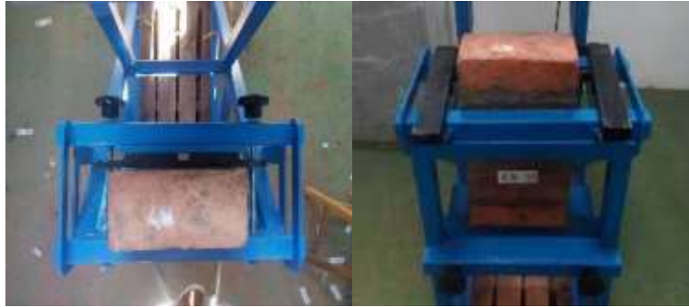
Figura 56. Montaje de prisma y juste de soporte inferior. Fuente: Autores.
