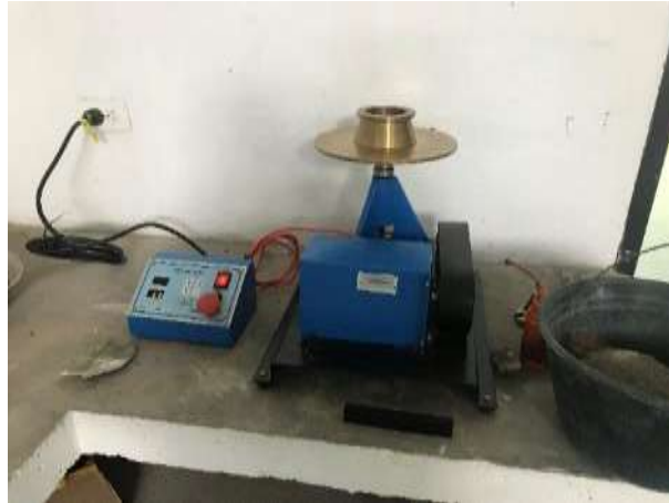
Figura 40. Calibración de mesa de flujo. Fuente: Autores.
