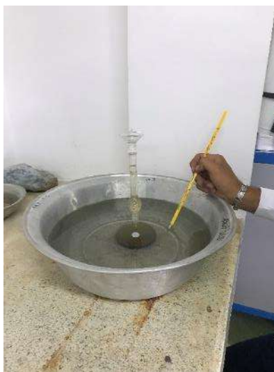
Figura 21. Ensayo determinación de la densidad del cemento hidráulico, toma lectura final, con control de temperatura.
