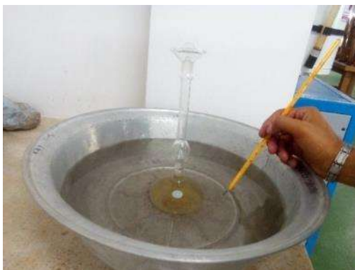
Figura 19. Ensayo determinación de la densidad del cemento hidráulico, toma de primera lectura, con control de temperatura.
