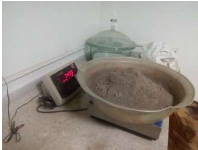
Figura 49. Proceso de pesaje de cemento para mezcla de mortero. Fuente: Autores.
