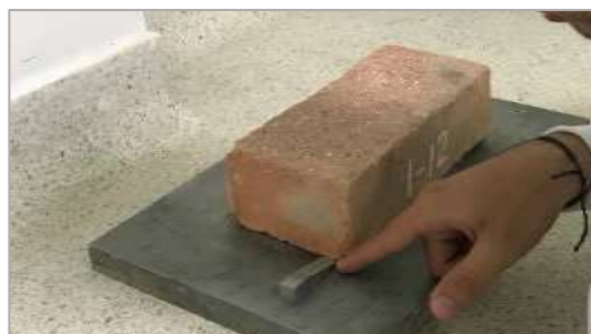
Figura 29. Ensayo medición de alabeo, medición alabeo convexo. Fuente: Autores.
