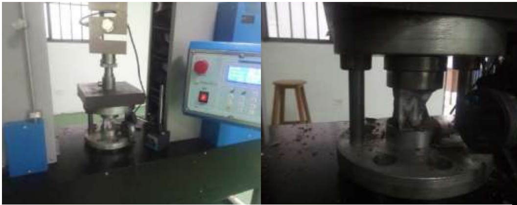
Figura 45. Falla de cubo de mortero. Fuente: Autores.
