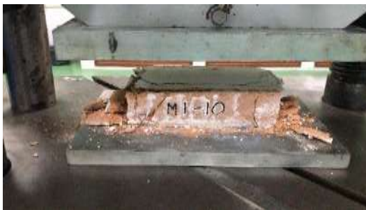
Figura 37. Ensayo resistencia a la compresión unidades de mampostería, falla de espécimen.
