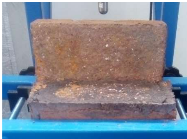
Figura 66. Falla a tope de junta ensayo resistencia a la flexión en juntas de mortero.
