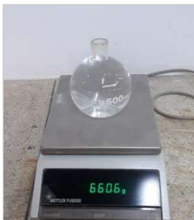
Figura 17. Ensayo densidad relativa del agregado, pesaje picnómetro más agua.
