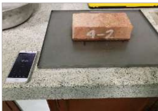
Figura 33. Ensayo tasa inicial de absorción, espécimen en contacto con el agua. Fuente: Autores.
