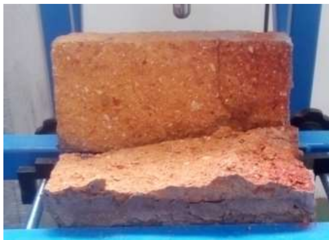
Figura 64. Falla por ladrillo ensayo resistencia a la flexión en juntas de mortero.
