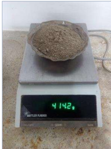
Figura 9. Ensayo determinación del contenido de humedad del agregado, pesaje muestra seca. Fuente: Autores.
