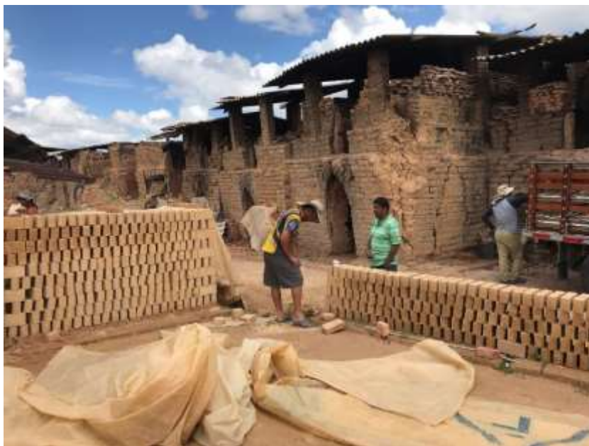
Figura 1. Hornos de fabricación artesanal de unidades de mampostería maciza de arcilla cocida Fabricante 1 (chircal 1).
