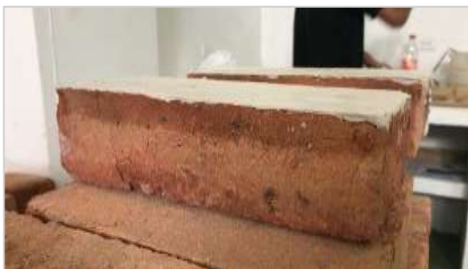
Figura 35. Ensayo resistencia a la compresión unidades de mampostería, refrentado con yeso de cara superior de espécimen de mampostería.
