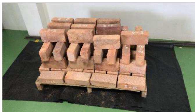
Figura 23. Preparación de unidades de mampostería para ensayos, enfriamiento y acopio. Fuente: Autores.
