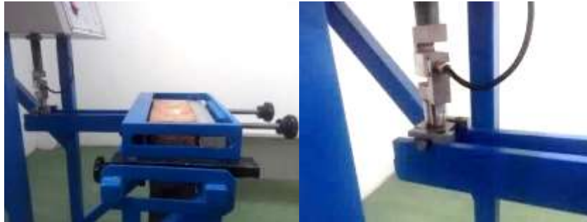
Figura 58. Centrado de ménsula superior y transductor de carga. Fuente: Autores.
