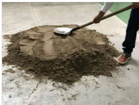
Figura 5. Método de cuarteo, conformación de pila cónica de la muestra de agregado. Fuente: Autores.
