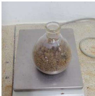
Figura 16. Ensayo densidad relativa del agregado, picnómetro con muestra del material.
