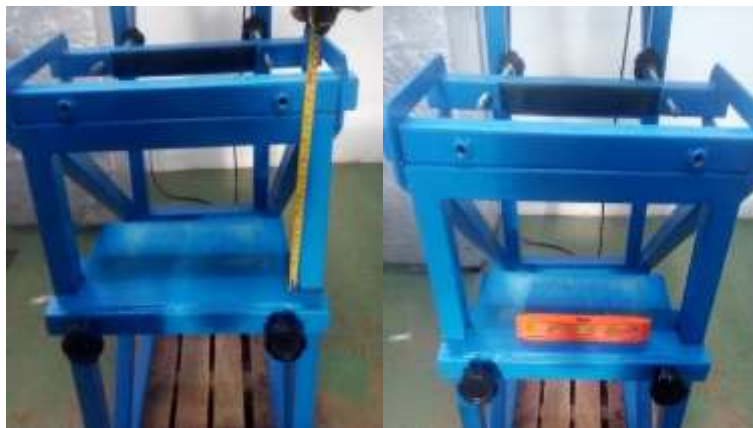
Figura 55. Posicionamiento y nivelación del soporte para muestra. Fuente: Autores.
