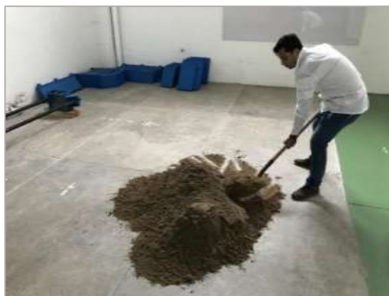
Figura 4. Método de cuarteo, mezcla manual del material. Fuente: Autores.
