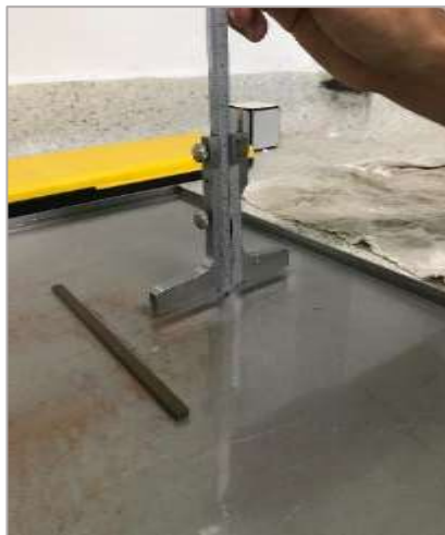
Figura 32. Ensayo tasa inicial de absorción, nivelación y llenado con agua de bandeja. Fuente: Autores.
