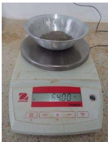
Figura 20. Ensayo determinación de la densidad del cemento hidráulico, pesaje de material 64 gr de cemento portland.
