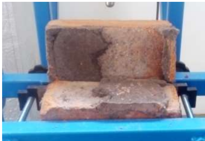
Figura 67. Falla de tope y fondo de junta ensayo resistencia a la flexión en juntas de mortero
