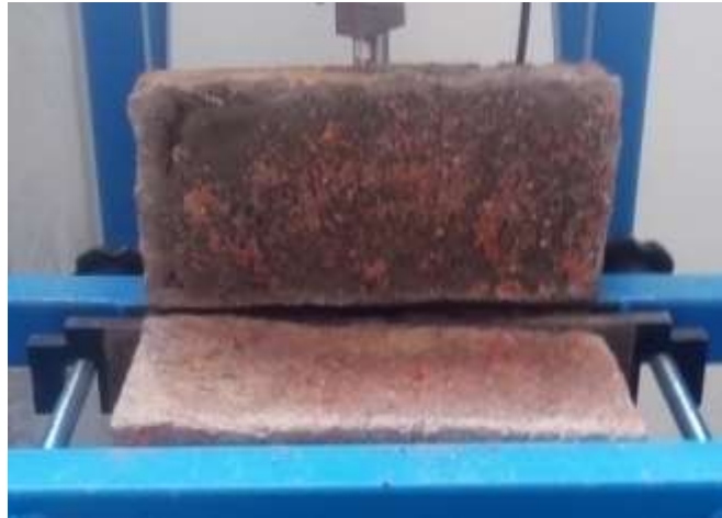
Figura 65. Falla a fondo de junta ensayo resistencia a la flexión en juntas de mortero
