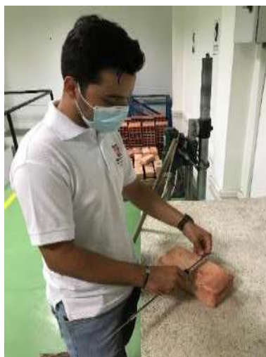
Figura 24. Ensayo determinación del tamaño unidades de mampostería, toma de medida del ancho del espécimen.
