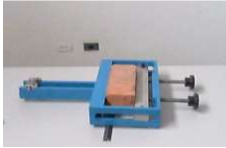
Figura 62. Determinación de centro de masa del brazo de carga. Fuente: Autores.
