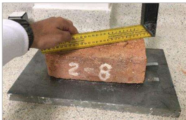
Figura 28. Ensayo medición de alabeo, medición alabeo cóncavo de la superficie. Fuente: Autores.
