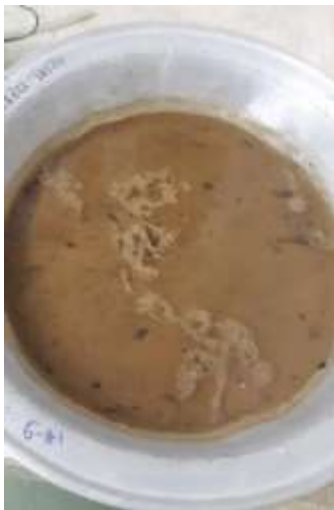
Figura 15. Ensayo densidad relativa del agregado, inmersión total de la muestra en agua.
