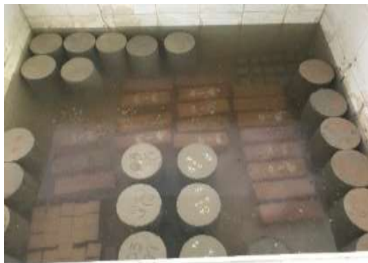
Figura 30. Ensayo inmersión durante 24 h, especímenes sumergidos totalmente. Fuente: Autores.
