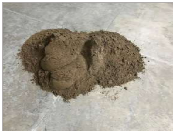
Figura 3. Método de cuarteo, muestra de agregado sobre superficie horizontal. Fuente: Autores
