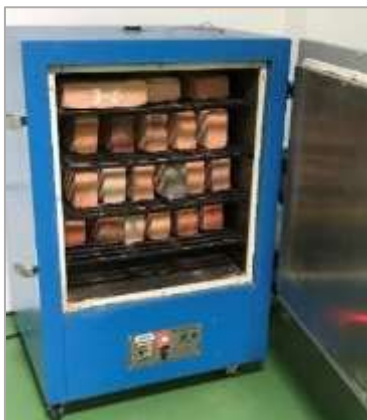
Figura 22. Preparación de unidades de mampostería para ensayos, secado en horno, durante 24 h. Fuente: Autores.
