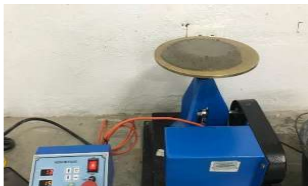
Figura 41. Deformación de mortero sobre mesa de flujo. Fuente: Autores.
