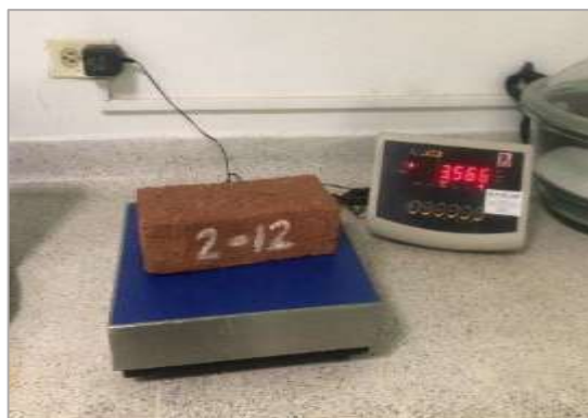
Figura 31. Ensayo de inmersión durante 24 h, pesaje espécimen húmedo. Fuente: Autores.
