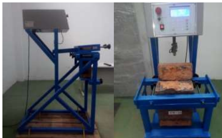
Figura 59. Falla de prisma. Fuente: Autores.
