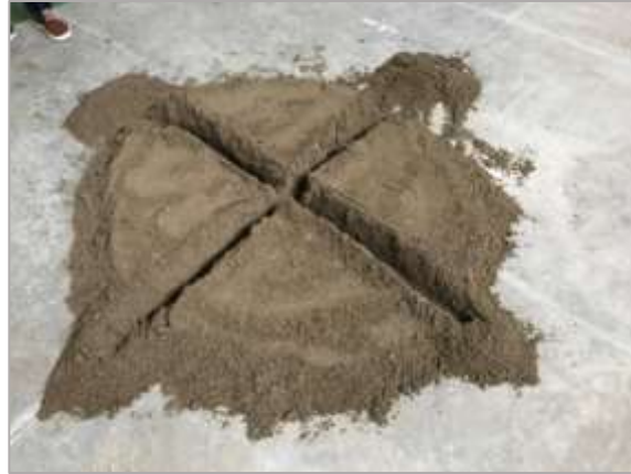
Figura 6. Método de cuarteo, división de la pila cónica de agregado en cuatro partes iguales. Fuente: Autores.
