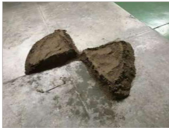
Figura 7. Método de cuarteo, retiro de cuartos diagonalmente opuestos de la pila de agregados. Fuente: Autores.
