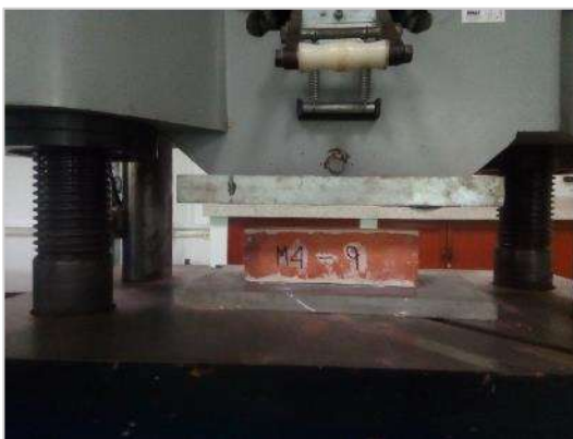
Figura 36. Ensayo resistencia a la compresión unidades de mampostería, espécimen posicionado sobre la máquina de ensayo.
