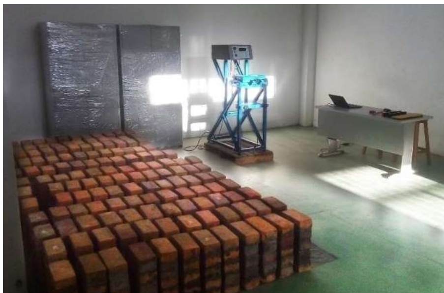
Figura 53. Ensayo de resistencia a la unión flexural de unidades de mampostería laboratorio de estructuras y sísmica UFPSO.
