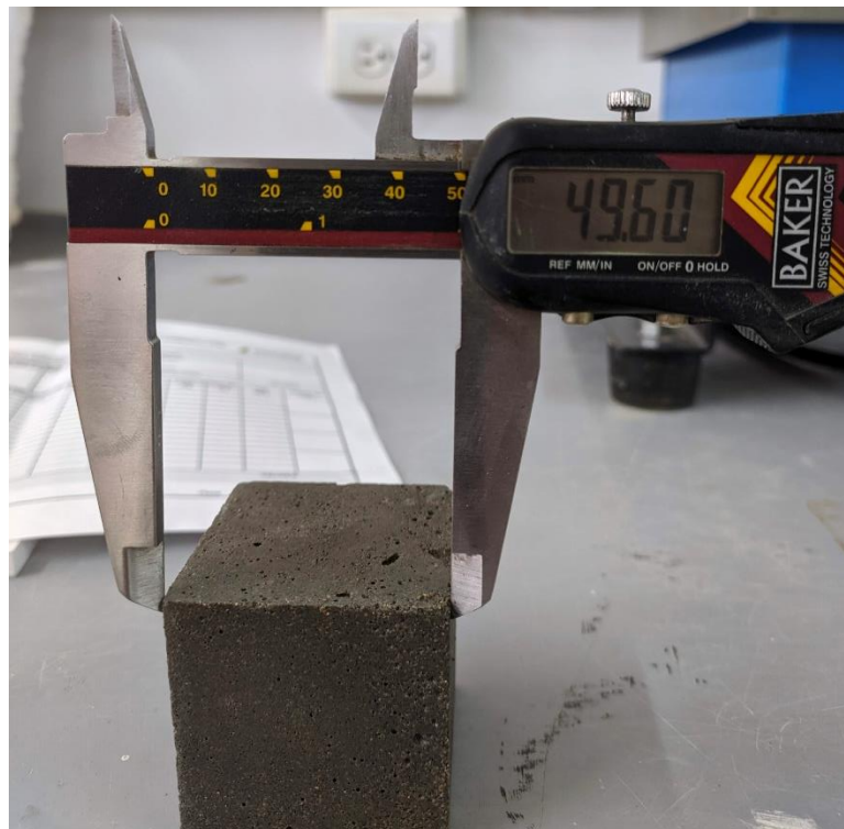
Figura 21. Medición de los lados de un cubo de mortero. (Autores, 2020)
