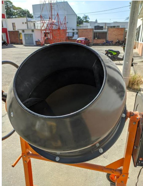
Figura 18. Mezclado de la arena gradada normalizada. (Autores, 2020)
