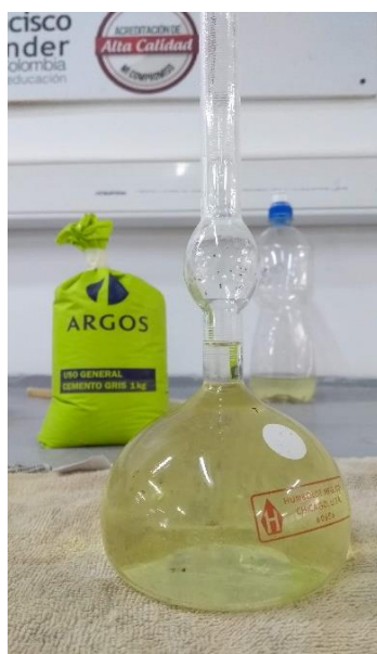
Figura 11. Ensayo de densidad del cemento. (Autores, 2020)
