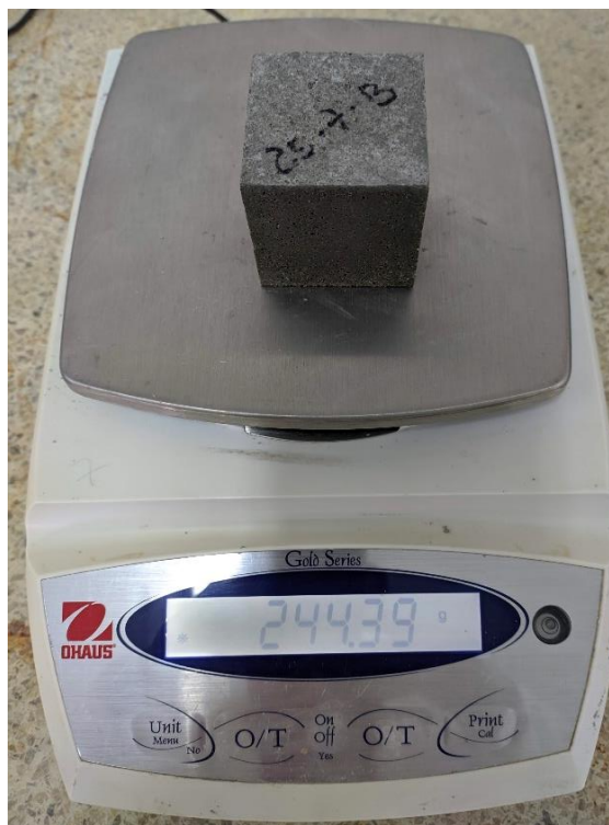
Figura 22. Medición de la masa de un cubo de mortero. (Autores, 2020)
