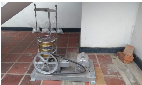
Figura 9. Tamizaje del residuo de vidrio. (Autores, 2020)
