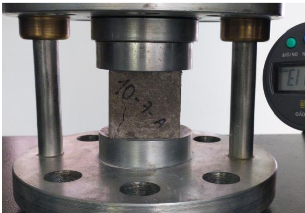
Figura 25. Ensayo de resistencia a la compresión. (Autores, 2020)
