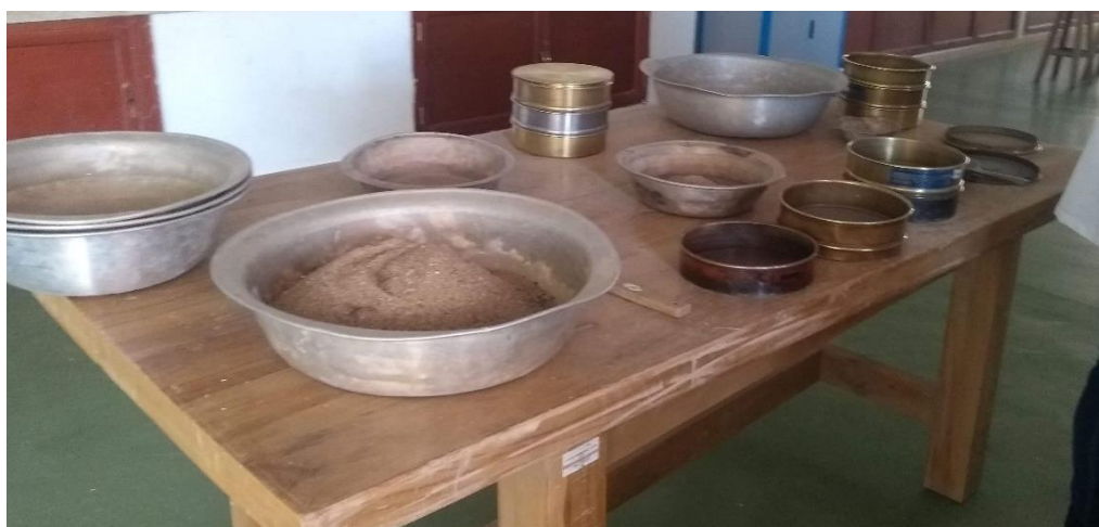
Figura 17. Tamizado de la arena gradada normalizada. (Autores, 2020)
