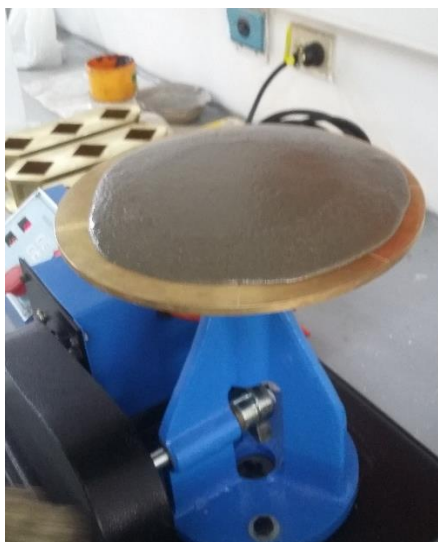
Figura 16. Ensayo de fluidez para determinar la fórmula de trabajo. (Autores, 2020)
