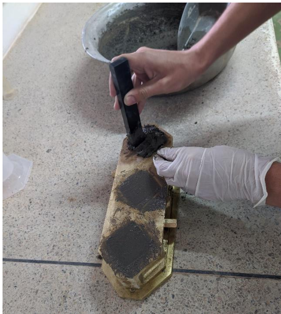
Figura 24. Compactación de cubos de mortero. (Autores, 2020)
