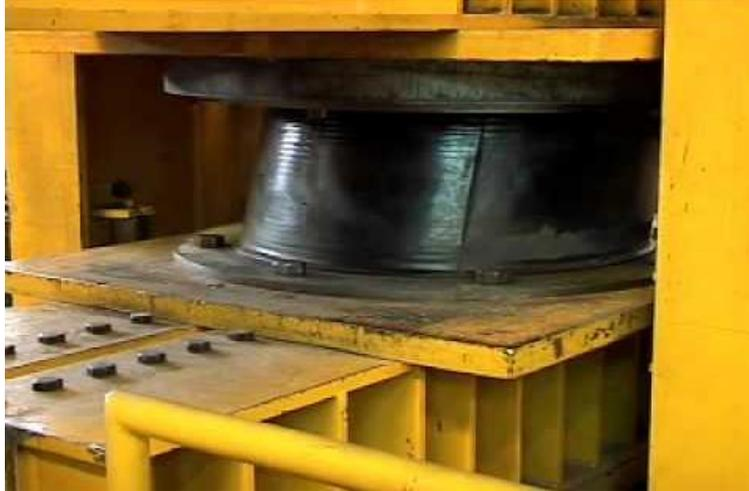
*Figura 17.* Aislador sísmico sometido a cargas de compresión. Docplayer.es, 2020. Obtenido en: <https://docplayer.es/84215677-Universidad-de-guayaquil.html>
