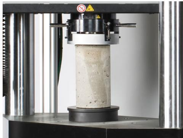
Figura 6. Prueba de compresión en probeta de concreto. Obtenido de Giraldo & Ramos, 2014.
