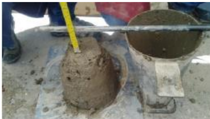
Figura 2. Prueba de asentamiento del concreto. Obtenido de: Coapaza, H. & Cahui, R. Influencia del aditivo superplastificante en las propiedades del concreto F'_{C}=210 \text{ KG/CM}^2 como alternativa de mejora en los vaciado de techos de vivienda autoconstruidos en puno . Pág. 18.
