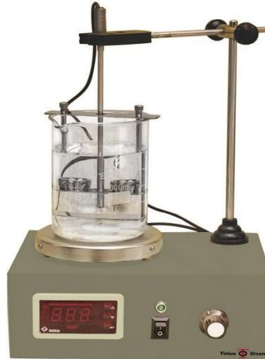
*Figura 25.* Equipo para el ensayo de punto de ablandamiento. Obtenido en: <https://www.directindustry.es/prod/tinius-olsen/product-29300-2005290.html>
