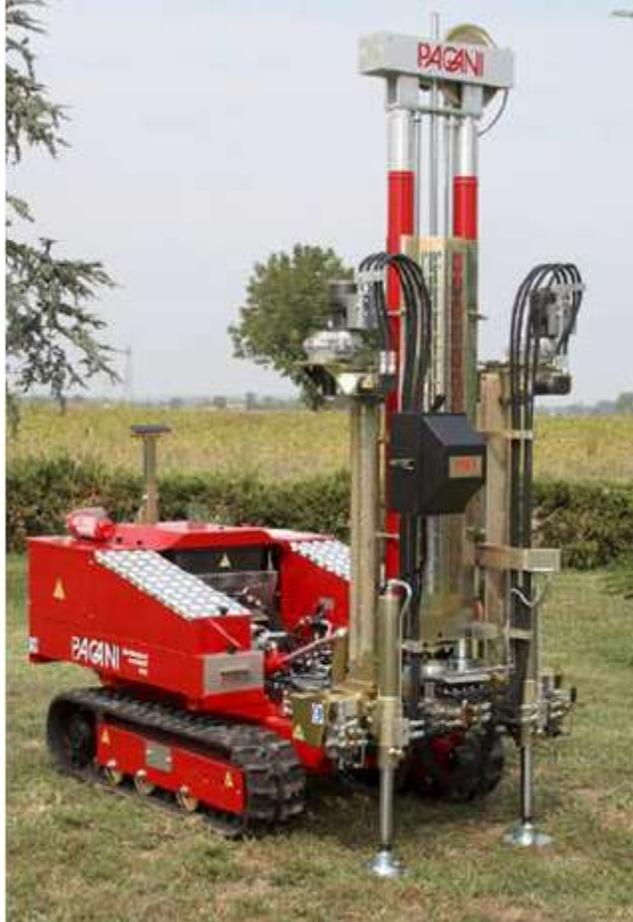
*Figura 3.* Equipo para la realización de un ensayo CPT. Obtenido en: Herrera & Castilla, 2012.
