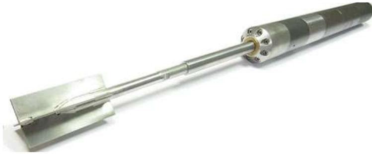
*Figura 6.* Equipo principal para ejecutar el ensayo VST. Obtenido en: Tecprosa, 2020. Link: <http://www.scptu.com/Equipo/Veleta.aspx>
