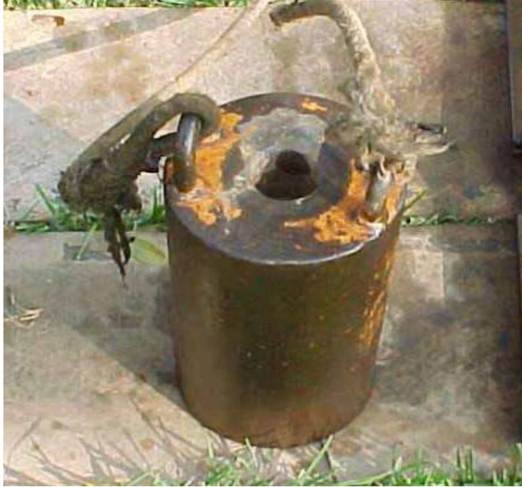
*Figura 9.* Martillo para ensayo SPT. Obtenido de Alva, 2016.
