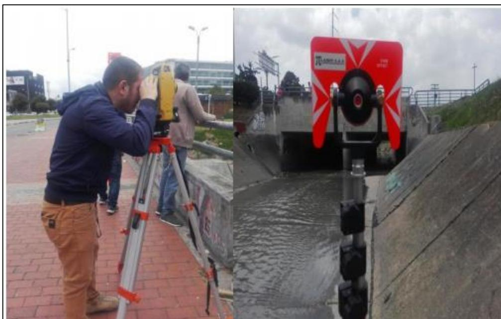
Figura 35. Toma de puntos con la ayuda de una estación topográfica y prisma. Moya y Álvarez (2018).
