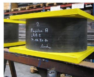
1 Ensayo sobre aisladores LASTO®LRB 2 Producción de aisladores LASTO®LRB
