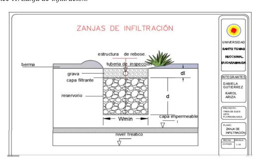
Nota. La imagen muestra el plano de la alternativa de la zanja de infiltración. (Gutiérrez & Ariza, 2020).
