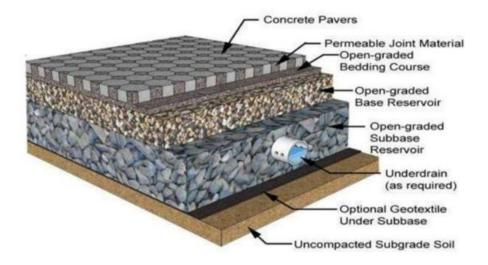
Nota. Estructura de pavimento permeable sugerido para la urbanización Carolina,(Castro, et al, 2008)
