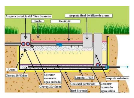
*Nota.* En la Figura se observan las partes de un filtro de arena (Abellan, 2015)
