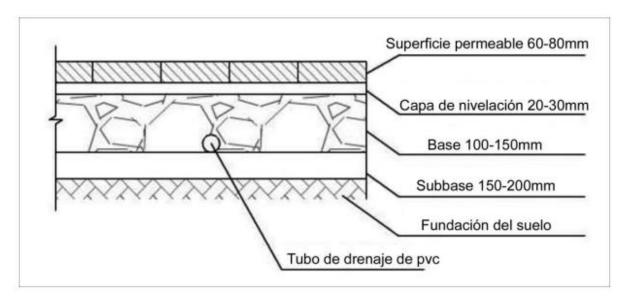
Nota. La imagen muestra el esquema del pavimento permeable. (Xue, 2020).
