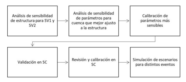
Nota. La imagen muestra el esquema del procedimiento que se llevó a cabo. (Srur, 2020).
