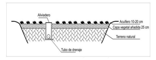
Nota. La imagen muestra el esquema de un espacio verde hundido. (Xue, 2020).
