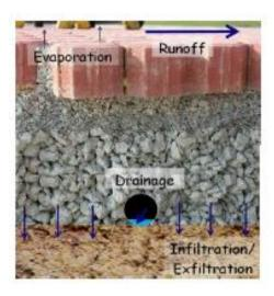
*Nota.* En la figura se observa las capas que conforman la sección típica de un pavimento permeable. (William, 2008)
