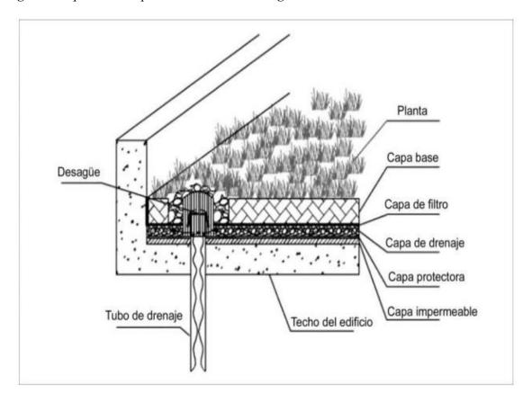
Nota. La imagen muestra el esquema de una cubierta vegetal. (Xue, 2020).
