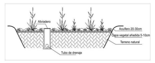
Nota. La imagen muestra el diagrama de estructura de la retención biológica. (Xue, 2020).
