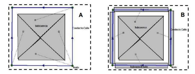
*Nota.* La imagen muestra el esquema de la modelación de las subcuencas con los parámetros planteados. (Srur, 2020).
