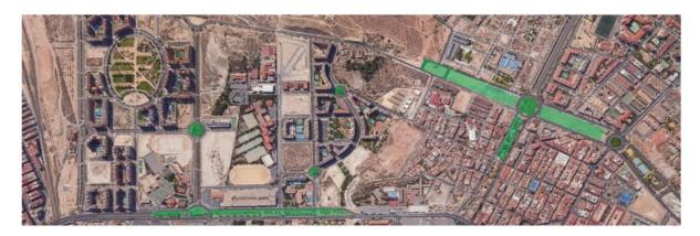
Nota. La imagen muestra la ubicación de los depósitos de infiltración. (Trapote & Fernández, 2016)
