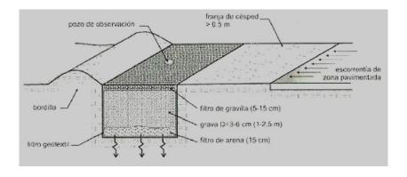
*Nota.* En la figura se observa el funcionamiento de una zanja de infiltración. (Abellan, 2015)
