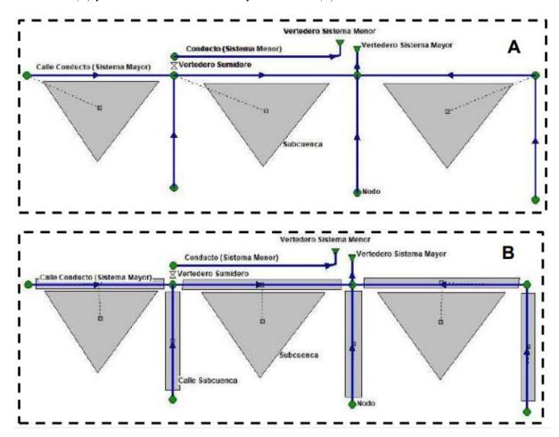
*Nota.* La imagen muestra el esquema de la modelación representando las calles como conductos (A) y calles como subcuencas y conductos (B). (Srur, 2020).
