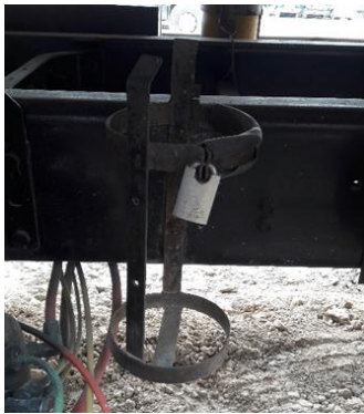
Ilustración 27. Ausencia del extintor 2 en el Carrotanque XMB027
