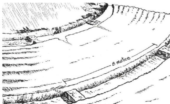
Figura 11. Canales de drenaje para desviación de corrientes de agua en zonas de pendiente.
