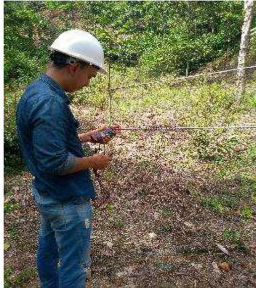
*Fotografía 17. Medición voltaje con pinza amperimétrica. Elaboración Propia*
