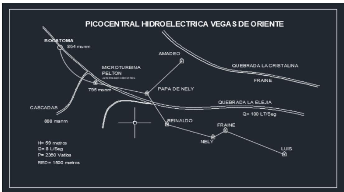
**Figura 3.** Salida gráfica del sistema energético Vegas de Oriente.
