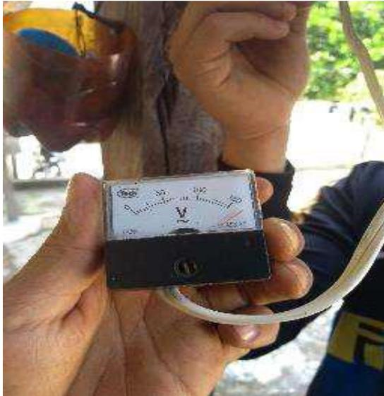
*Fotografía 16. Medición con voltímetro de la energía eléctrica suministrada a la vivienda. Elaboración Propia*
