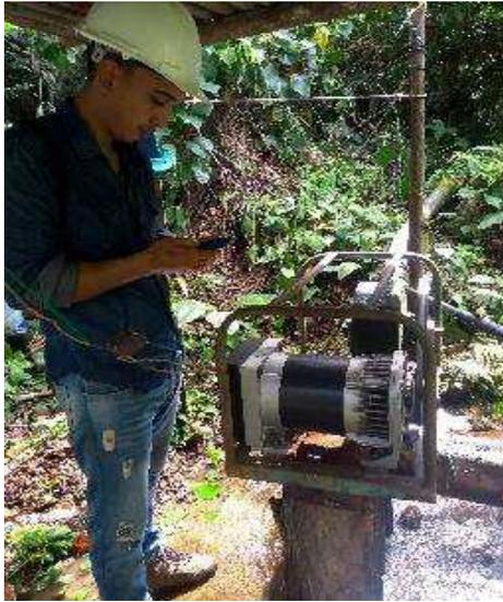
*Fotografía 9:* Verificación de emisión de sonido de la máquina. Elaboración Propia
