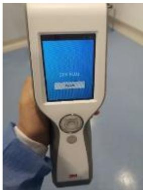
*Figura 8.* Resultado luminometría piso.
