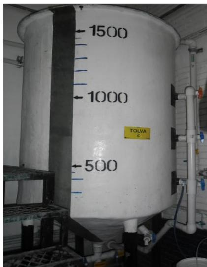
Figura 27. Tolda de acondicionamiento con ajuste de válvulas de succión
