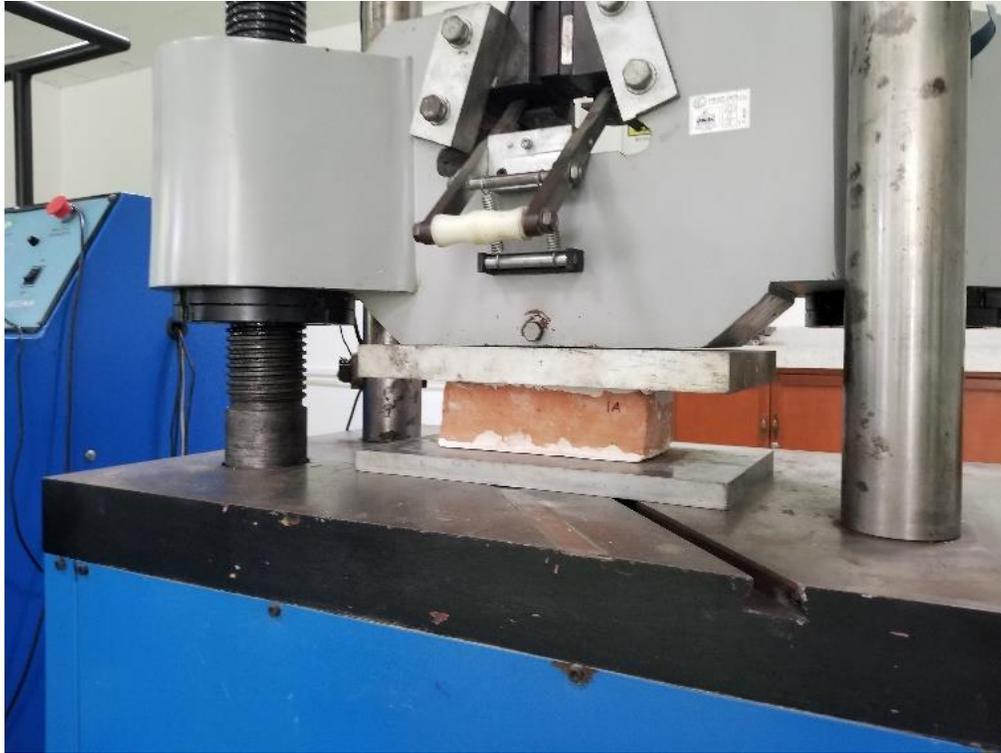
*Figura 13.* Colocación del espécimen para ensayo de compresión.
