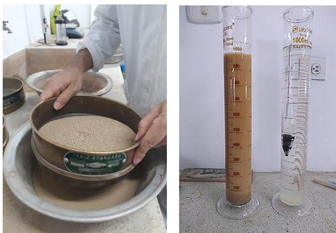
Figura 3. Tipos de tamices utilizados en el ensayo, ejemplo de tamiz No.40 y ensayo de Hidrómetro en la muestra de estudio.
