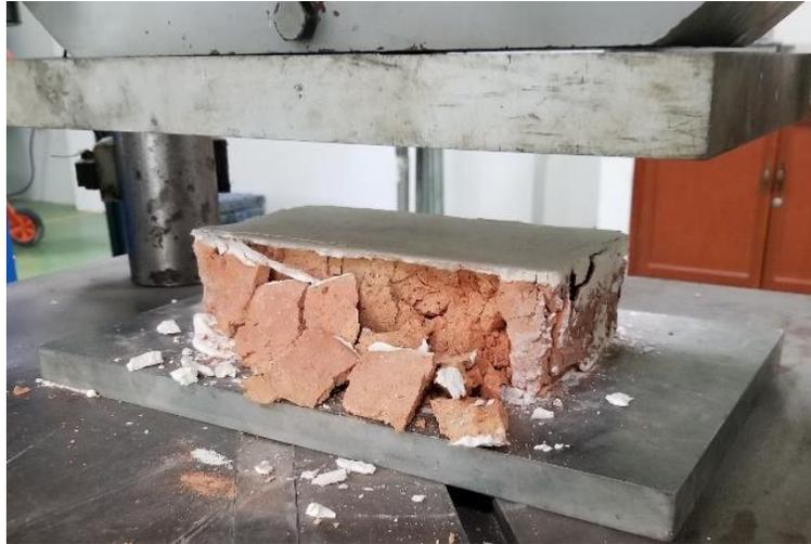
*Figura 22.* Especimen después de la aplicación de la carga a compresión.
