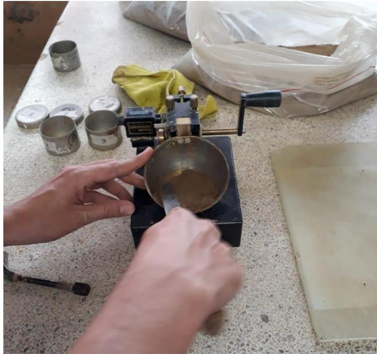
*Figura 16.* Ensayo de Limites de Plasticidad.
