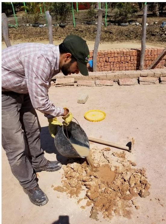
*Figura 7.* Mezcla de los diferentes componentes usados en la elaboración del ladrillo.
