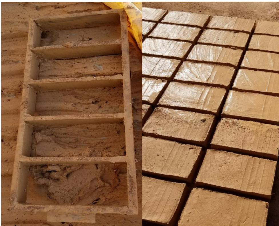
Figura 8. Marco para el moldeado y secado al sol del ladrillo.
