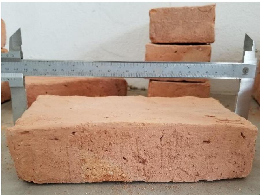
*Figura 11.* Dimensionamiento de especímenes mediante un calibrador.
