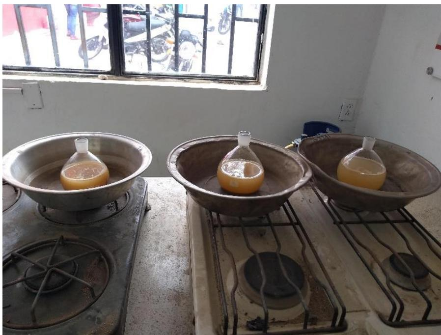
Figura 4. Ensayo determinación de la gravedad específica fracción fina.
