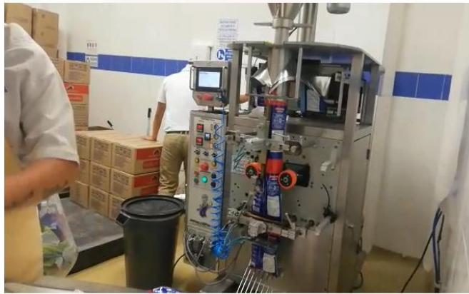
Figura 26. Empacadora. Fuente: Autor del proyecto (2020).
