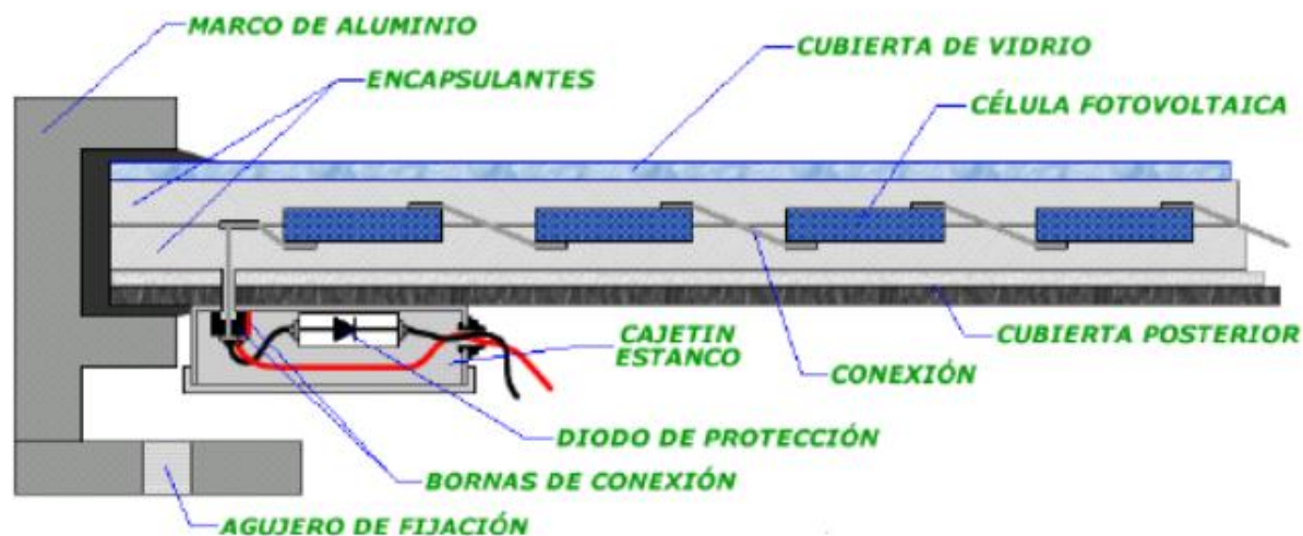
Figura 54. Elementos de un panel Fotovoltaico.
