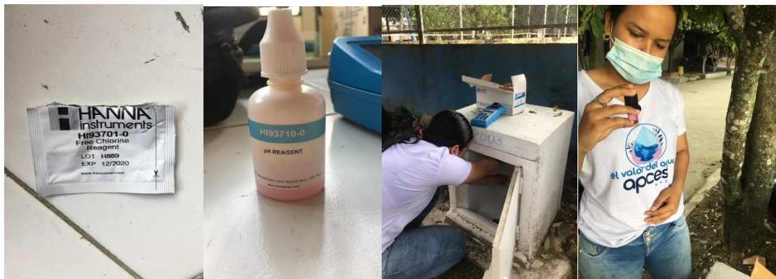
Figura 36. Verificación de parámetros en red de distribución con equipo fotómetro multiparamétrico portátil. Elaboración propia
