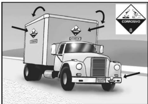
Figura 32. Requisitos de la unidad de transporte, incluido el número de la ONU y la sustancia peligrosa. Fuente. IDEAM (2017)
