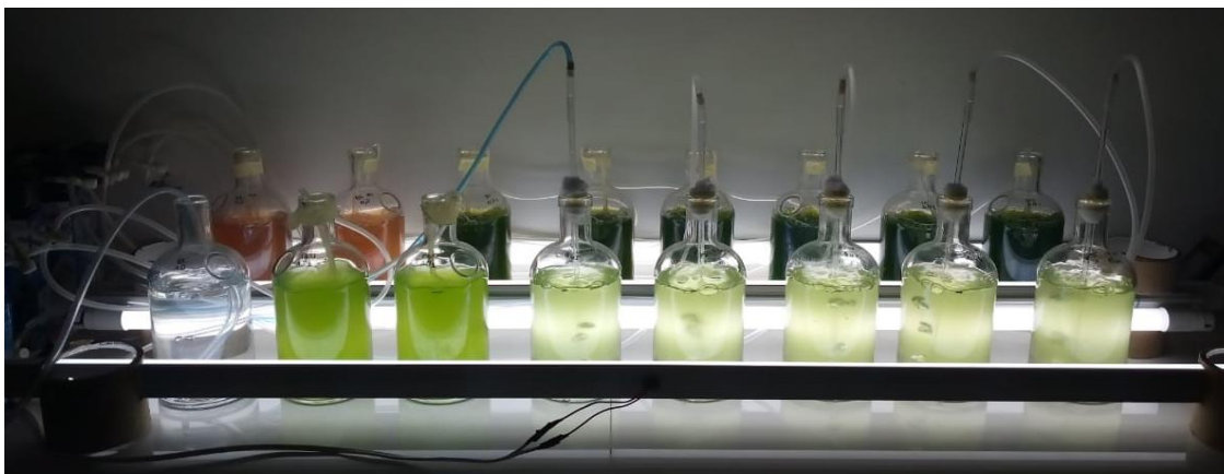
Figura 7. Montaje piloto para producción del cultivo microalgal y tratamiento de aguas residuales del proyecto porcino de la UFPSO.
