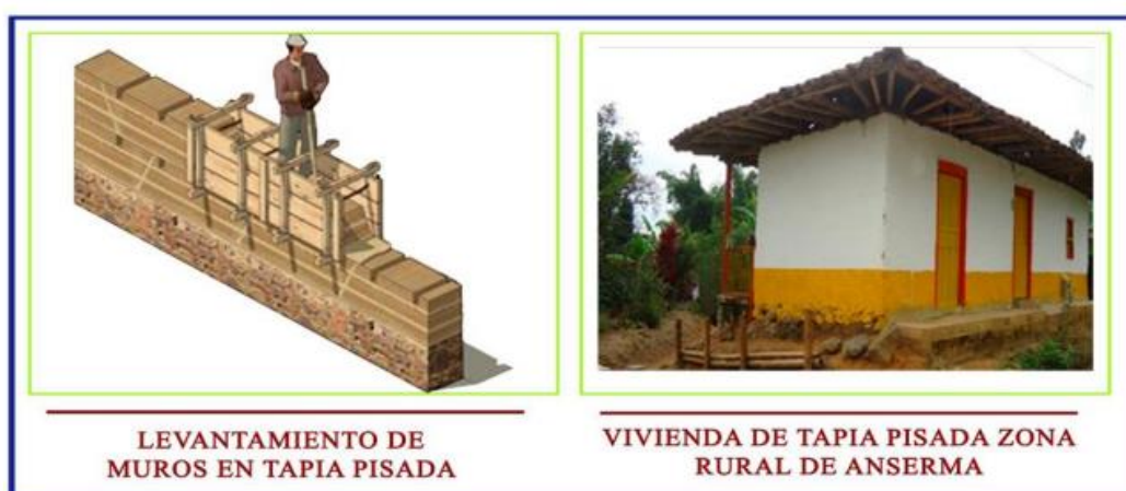
Figura 8. Levantamientos de muros y viviendas construidas con la técnica de tapia pisada
