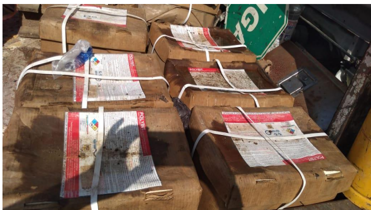
Fotografía 44. Cajas de POLYBIT en mal estado a causa del agua. Fuente: Autor del proyecto (2019).
