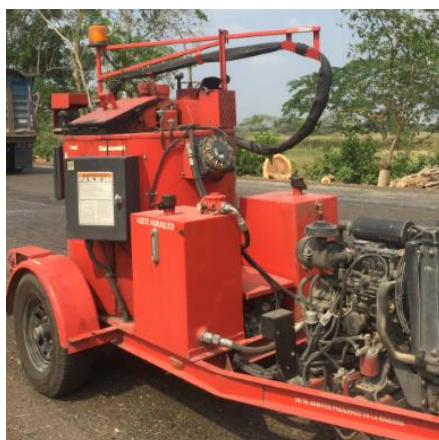
Fotografía 15. Máquina derretidora de asfalto. Fuente: Autor del proyecto (2019)
