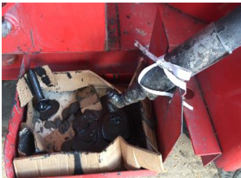
Fotografía 1010. Residuos de material sellante POLYBIT provenientes del escurrimiento de la boquilla para su aplicación en la maquina derretidora. Fuente: autor del proyecto (2019).
