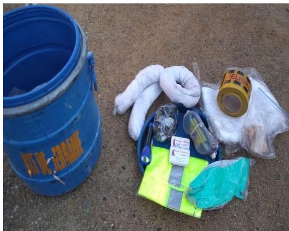
Fotografía 20. Kit anti derrames grúa. Fuente: Autor del proyecto (2019).
