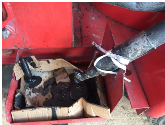
Fotografía 42. Desperdicio de material al momento de reposar la pistola. Fuente: Autor del proyecto (2019)
