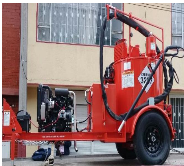
Fotografía 28. Derretidor de asfalto. Fuente: Autor (2019).
