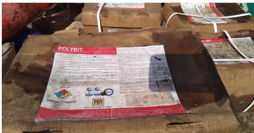
Fotografía 43. Cajas de POLYBIT dañada a causa del agua. Fuente: Autor del proyecto (2019)
