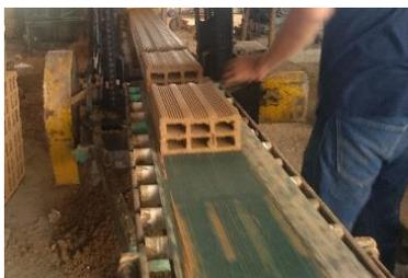
**Figura 13.** Pre-cortado y cortado. **Fuente:** Autor, 2019.
