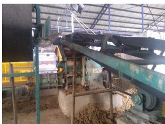
**Figura 10.** Bandas transportadoras a extrusión.
