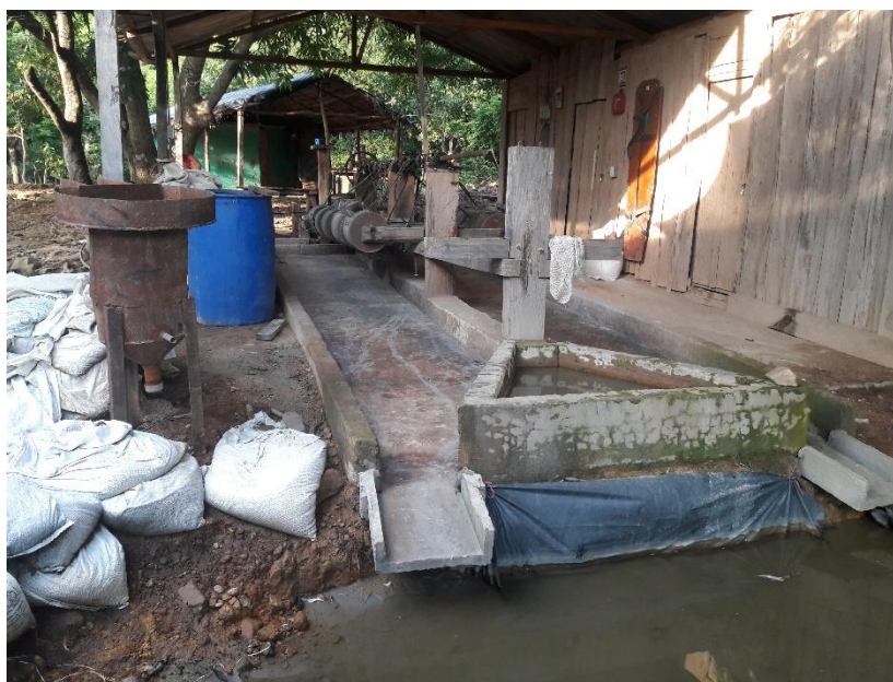
Molienda artesanal (cocos) con mercurio
