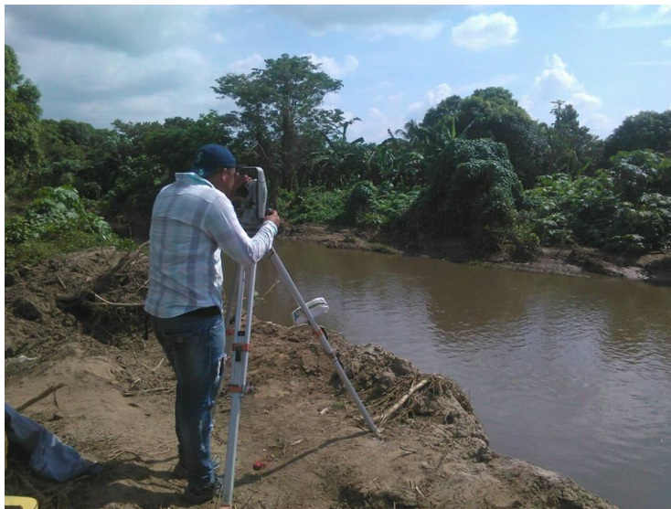
Figura 50 levantamiento topográfico y batimétrico del tramo de la quebrada la floresta Nota. Elaboración Propia
